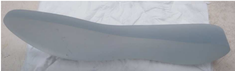
Figura 12. Modelo de la suela completa en SLA tal y como sale de máquina
