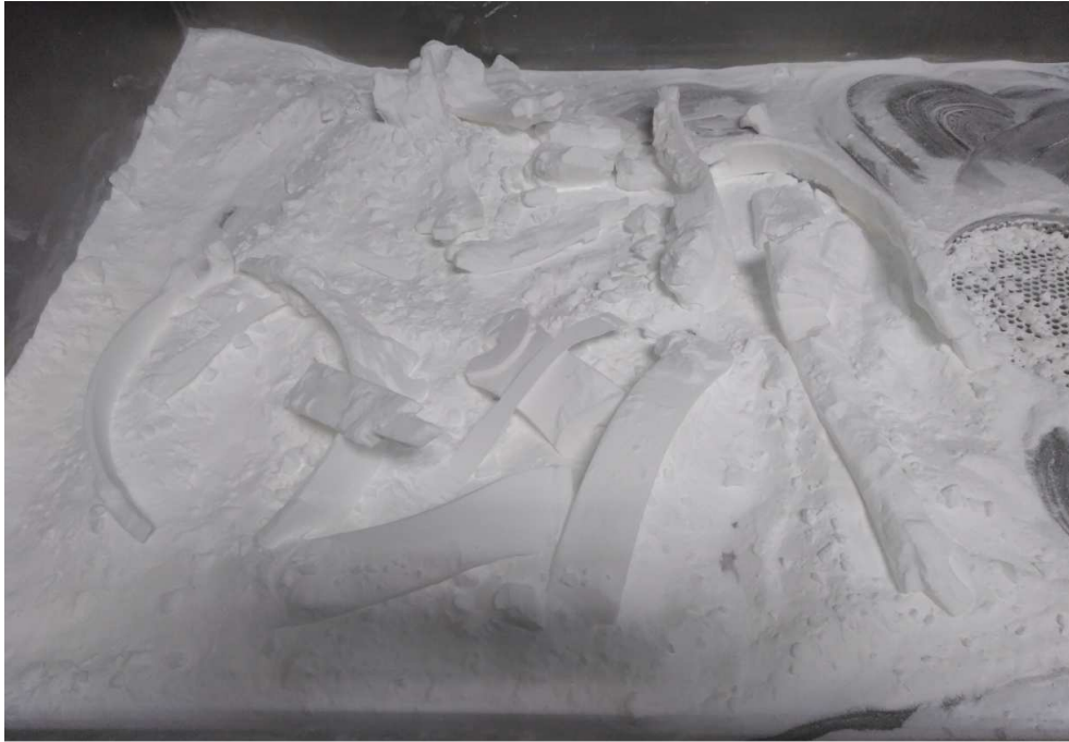
Figura 19. Proceso de enfriamiento de las piezas tras su fabricación
