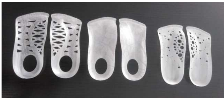
Figura 8. Soportes rígidos de las plantillas fabricadas en FDM con el material Bendlay
