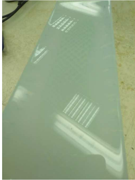
Figura 16. Curado de la suela elastomérica con estructura en el molde
