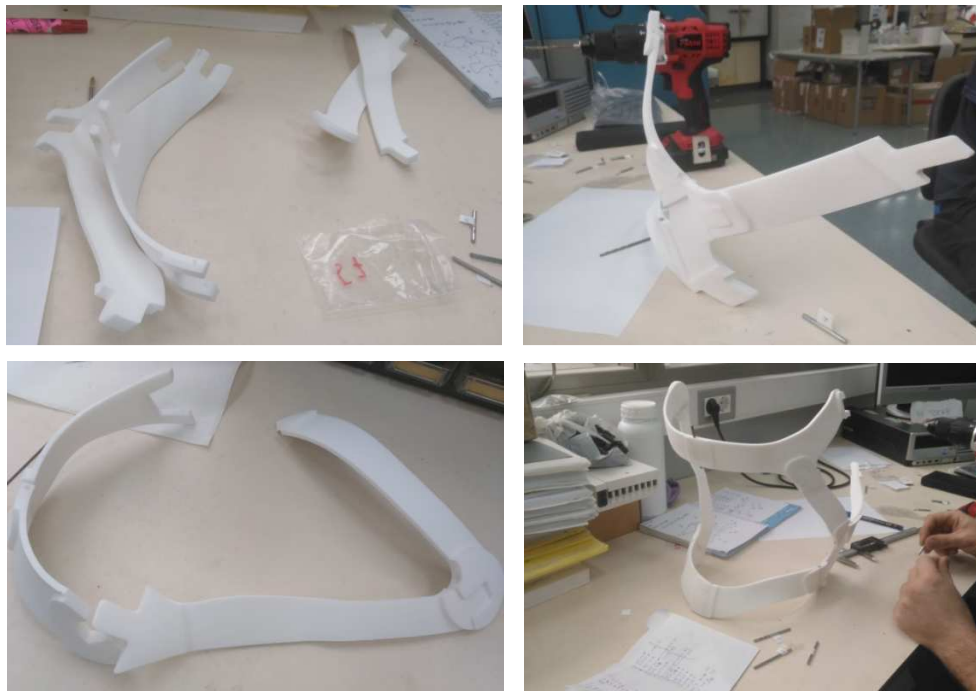
Figura 20. Proceso de montaje del corsé
