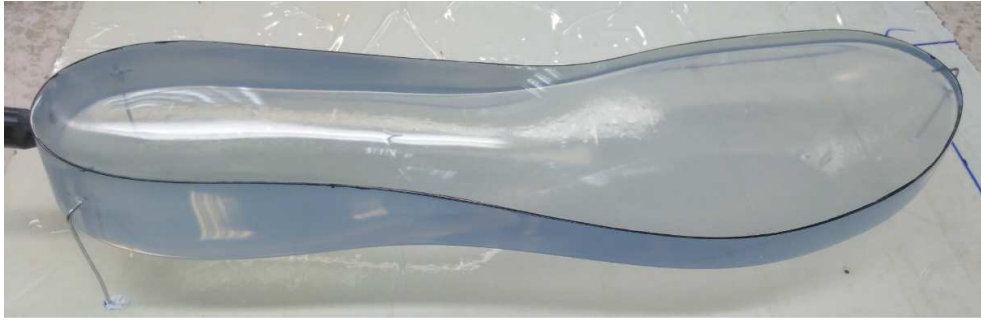
Figura 13. Modelo de la suela completa en SLA pulido y acabado
