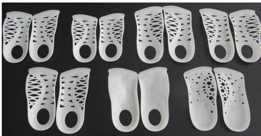
Figura 4. Soportes rígidos de las plantillas fabricadas con la tecnología SLA en resina NEXT
