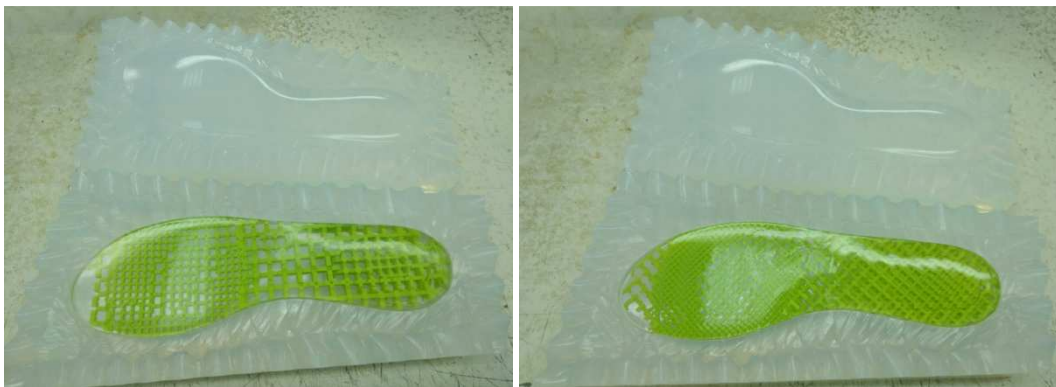
Figura 17. Apertura del molde con las dos estructuras fabricadas
