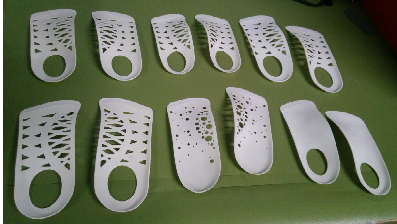
Figura 6. Soportes rígidos de las plantillas fabricadas con la tecnología SLS en poliamida
