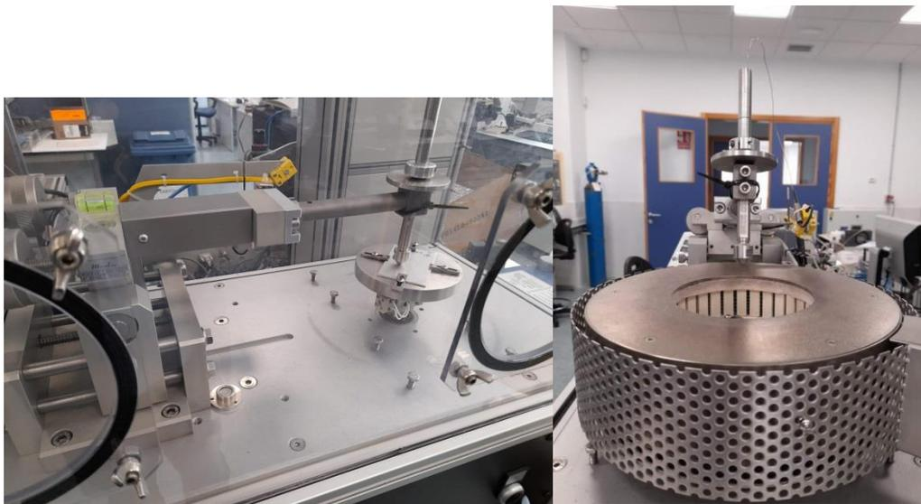
Figura 15. Detalle donde se puede ver el equipo de desgaste durante la ejecución de un ensayo. En la derecha podemos ver el horno sobre el tribómetro.
