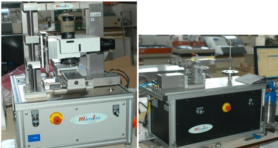
Figura 13. Equipos de caracterización superficial empleados en el proyecto. A la izquierda tribómetro y a la derecha el equipo de rayado.
