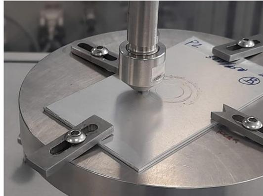
Figura 14. Detalle del desgaste de una de las muestras ensayadas en el proyecto.
