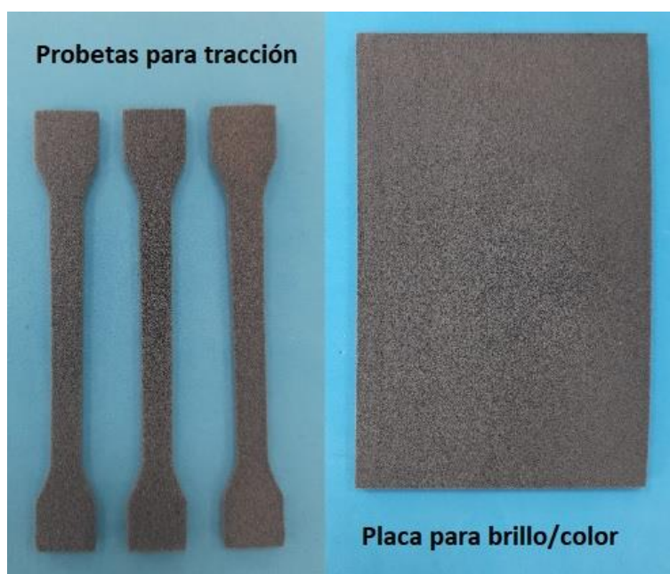
Ilustración 1. Probetas de tracción y placa para caracterización dimensional, de brillo y color, muestra SLS, Flexa Performance
