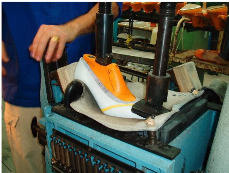
*Imagen 7. Proceso de prensado del calzado.*
