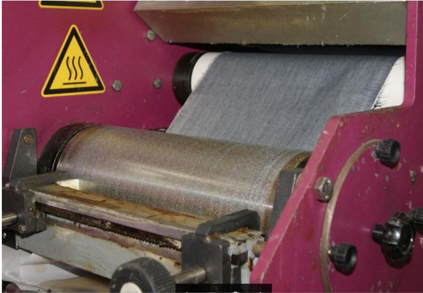
**Imagen 3. Detalle del sistema por cilindro grabado para aplicación de hot melts.**
