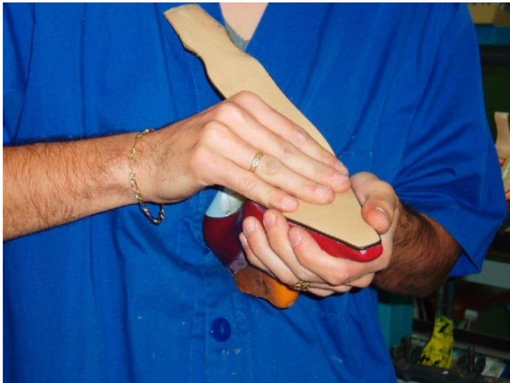
*Imagen 6. Unión corte-suela del calzado.*
