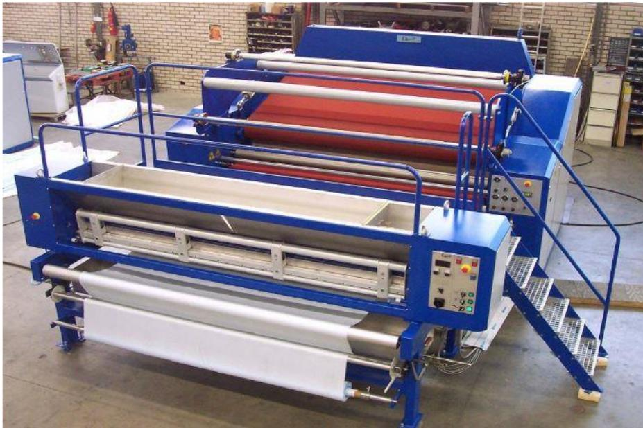
**Imagen 2. Sistema por cilindro grabado de aplicación de hot melts para protector de colchón. Instalación industrial.**
