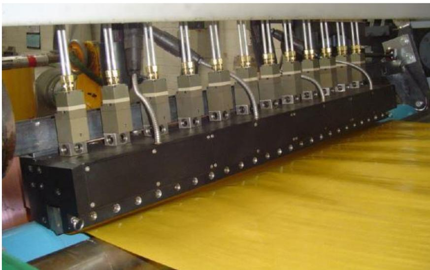
**Imagen 1. Laminado con hot melts con sistema de boquilla en la industria textil.**
