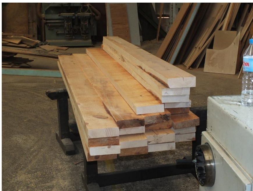
Figura 1. Madera para uso estructural de Pinus halepensis . Fuente: AIDIMME
