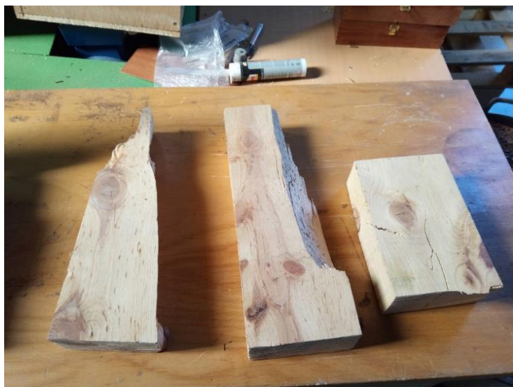
Figura 3. Nudos en madera de Pinus halepensis . Fuente: AIDIMME.
