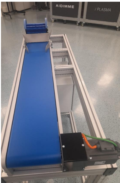
Ilustración 30. Cinta de banda con servomotor y guía del módulo móvil para inspección.
