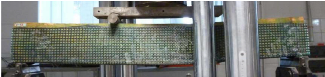
Viga de madera reforzada con una capa de polímero con fibra de carbono. Fuente: Rescalvo et al. (2017).
