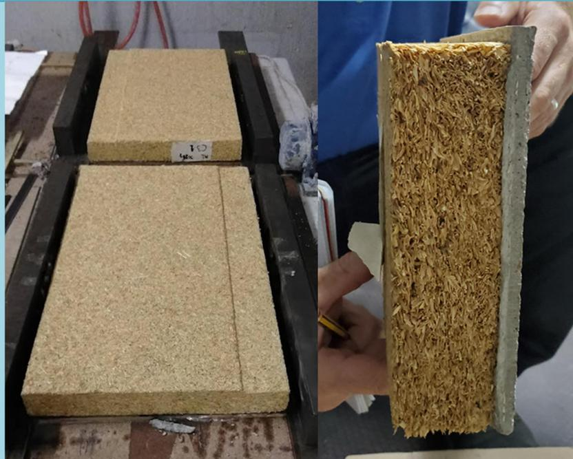
**Prototipo experimental de tablero aglomerado de cáscara de arroz adherido a una placa de hormigón. Fuente: AIDIMME**
