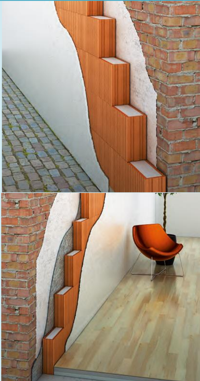
Imágenes del sistema de aislamiento Poroton WDF aplicado por el exterior (arriba) y por el interior (debajo). Fuente: Wienerberger
