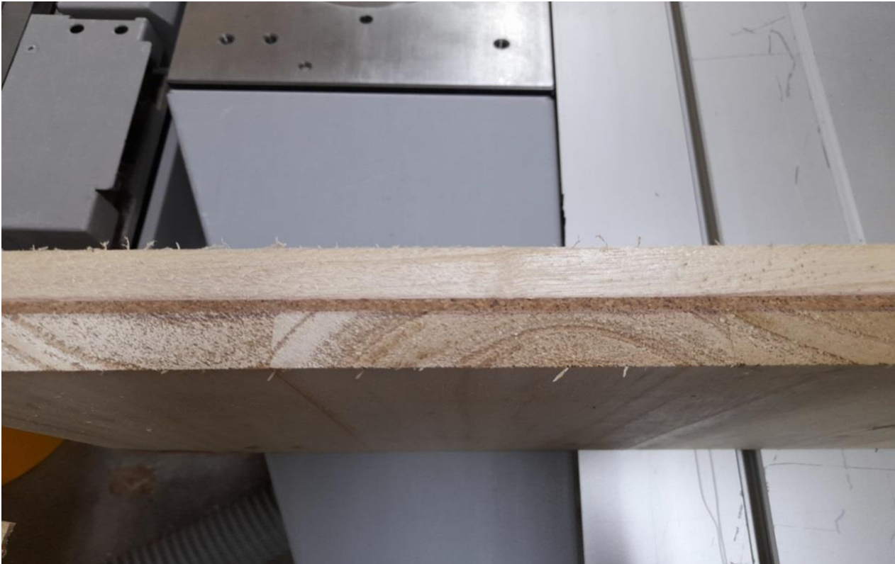
Imagen 13. Detalle transversal del tablero contralaminado de paulownia de 3 capas desarrollado en INNOCOND, después de su corte y lijado.
