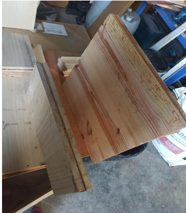
Imagen 11. Tableros contralaminados de paulownia (izquierda) y de pino (derecha) de 3 capas desarrollados en INNOCOND.
