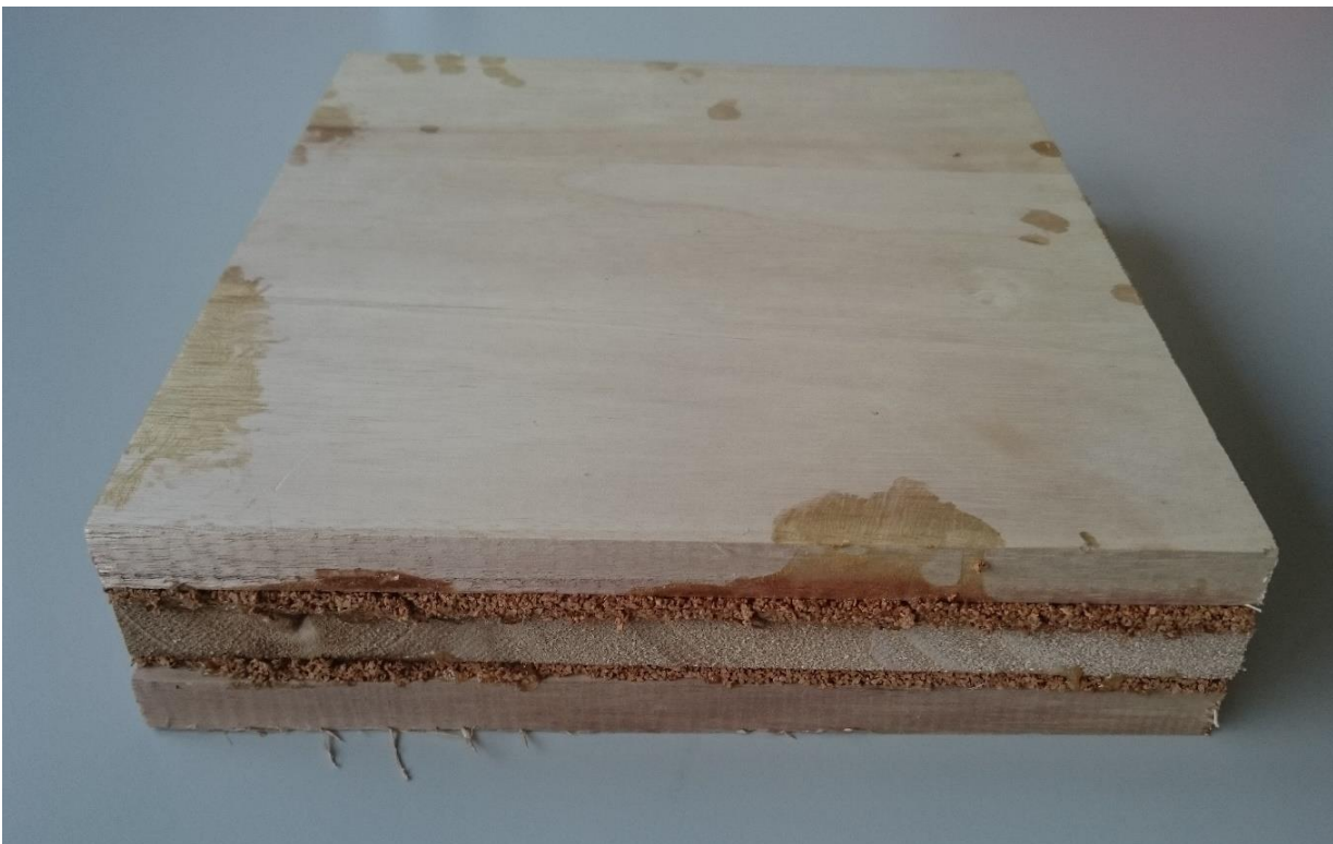
Imagen 12. Vista frontal del tablero contralaminado de paulownia de 5 capas desarrollado en INNOCOND, antes de su lijado.
