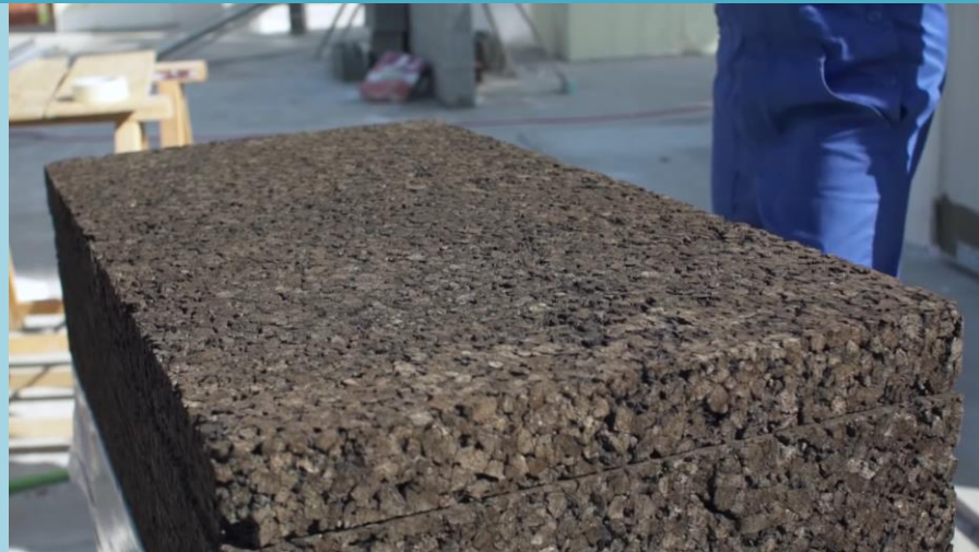
Aislante principal del sistema (corcho expandido). Fuente: Barnacork
