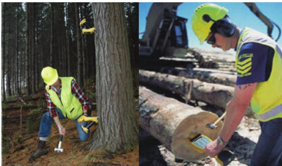
Figura 15. Medición de árboles en pie y trozas. Wang X. 2007.
