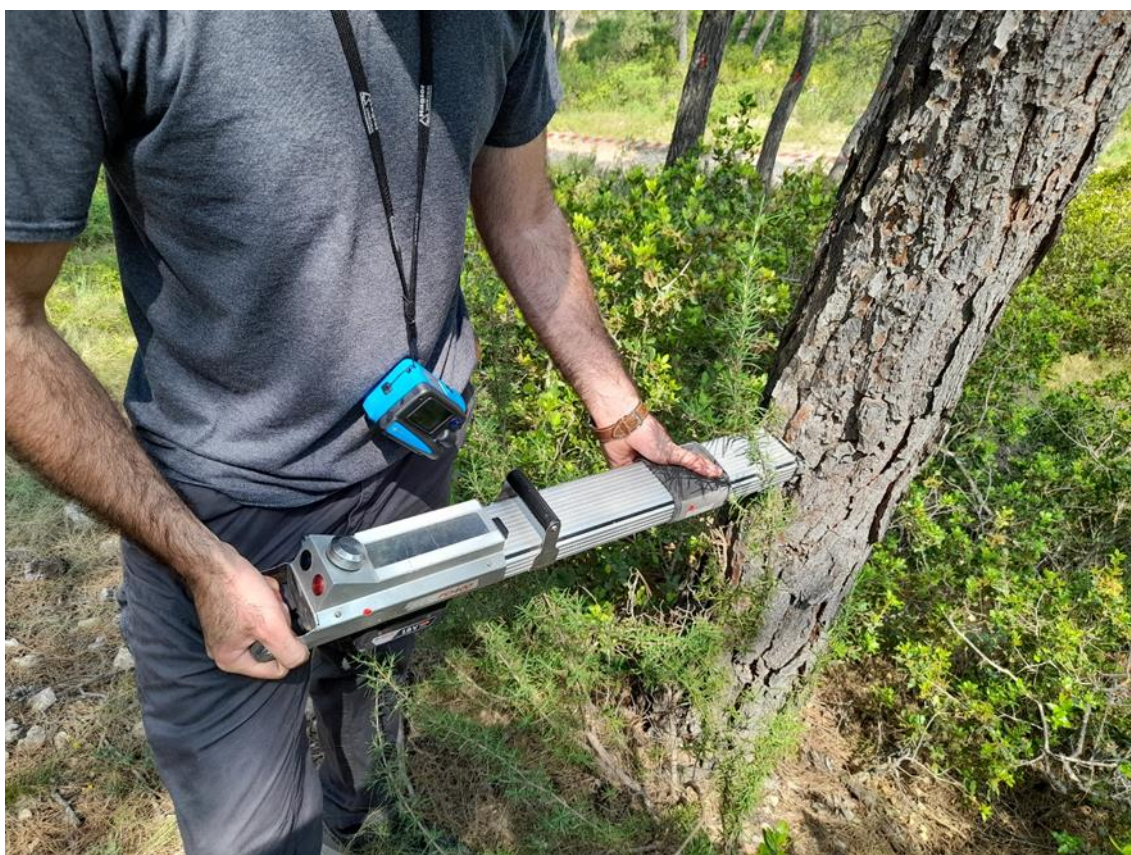
Figura 28. Ensayo equipo de resistografía sobre arbolado
