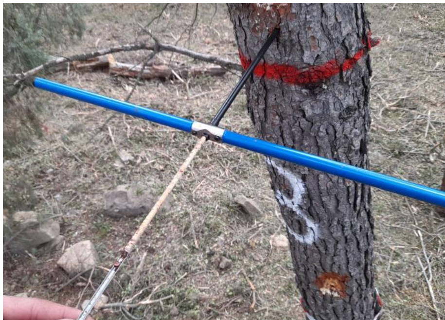
Figura 46. Extracción de probeta con barrena pressler.
