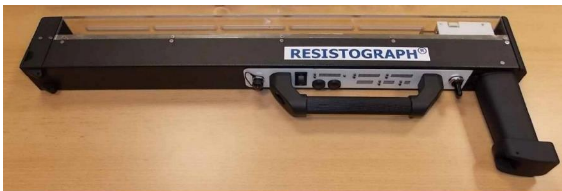
Figura 30. RESISTOGRAPH 6500. Versión más actual comercializado por Rinntech. Fuente Rinntech.
