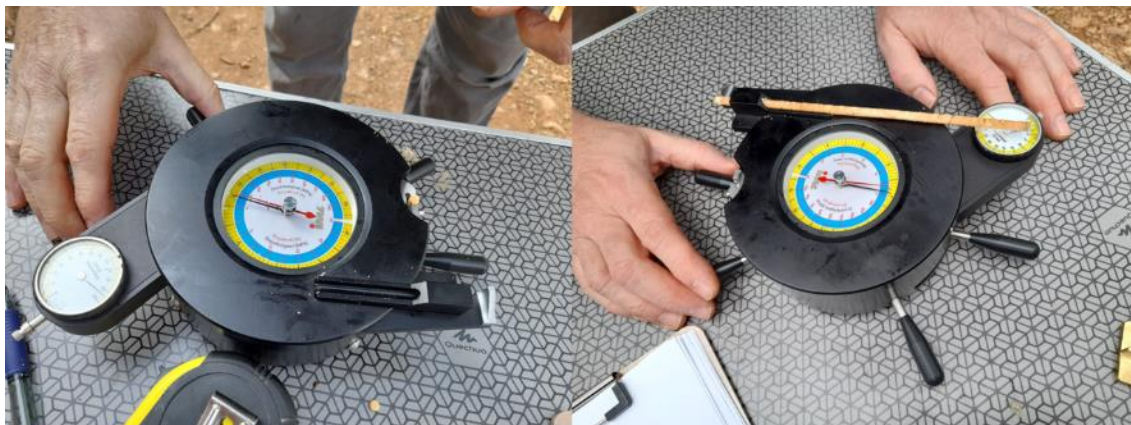
Figura 25. Equipo fractómetro realizando ensayo de compresión y flexión.
