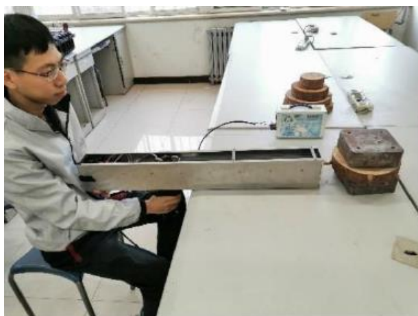
Figura 34. Medición de anillos sobre discos con equipo de perforación. Hu, X. et al en 2020.
