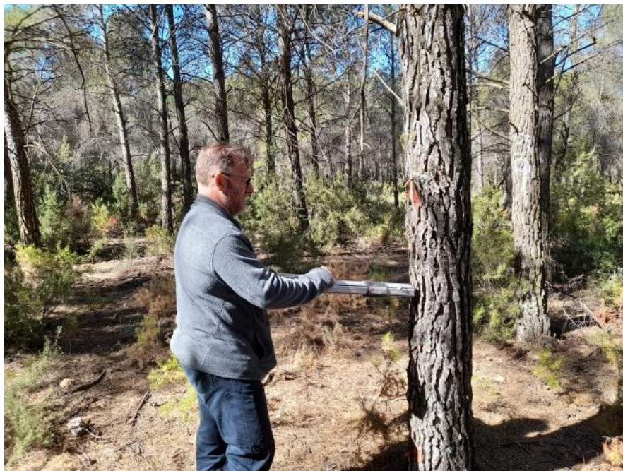
Figura 45. Ensayo de resistografía sobre árbol en pie.
