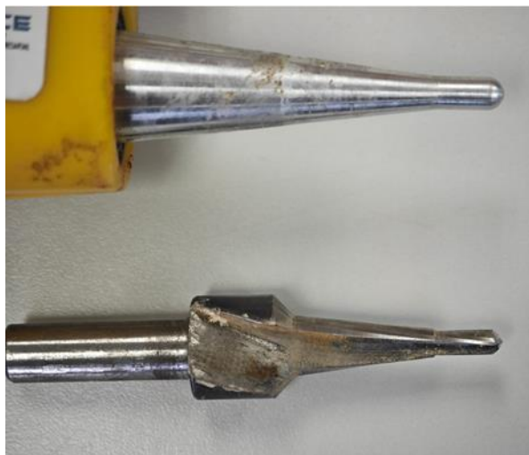
Figura 41. Broca que se emplea para la colocación de la sonda Sylvatest 4
