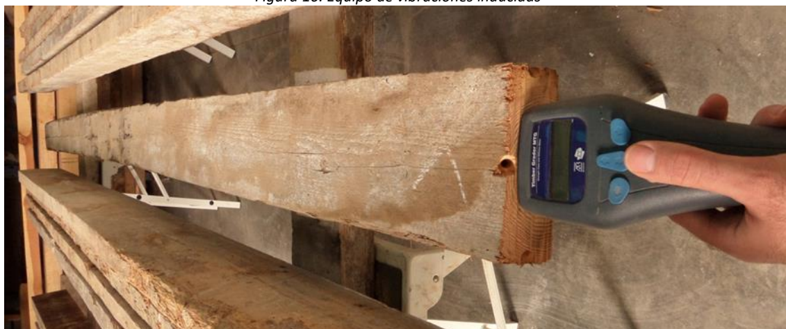
Figura 17. Ensayo con el equipo Timber grader MTG. Fuente: AIDIMME
