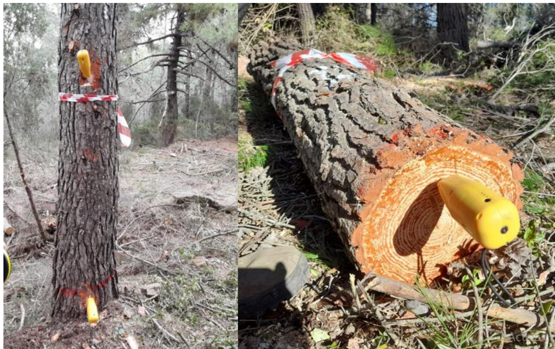
Figura 9. Medición de árboles en pie y de trozas con equipo Sylvatest.
