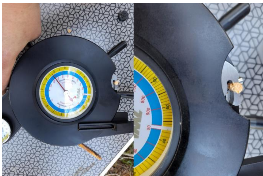
Figura 48. Ensayo de compresión con fractómetro.
