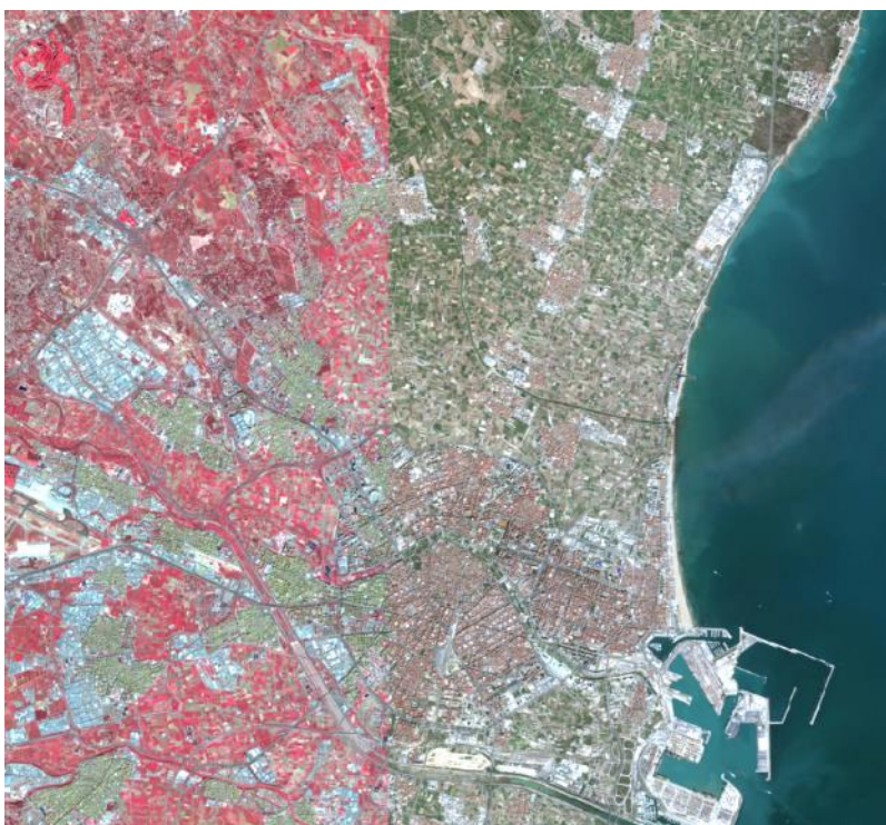
Figura 49. Imagen Sentinel-2 de la Comunitat Valenciana de 2022/10/02 en color verdadero (RGB) y en falso color infrarrojo (IRG) de 10 m de resolución. Fuente: Copernics sentinel Data – ESA
