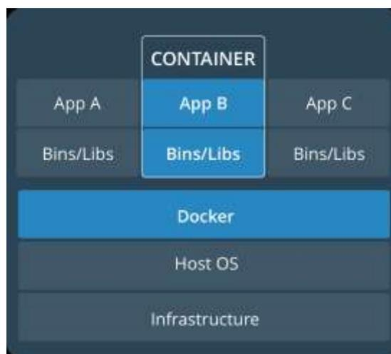
**Figura 3:** Diagrama de un contenedor
