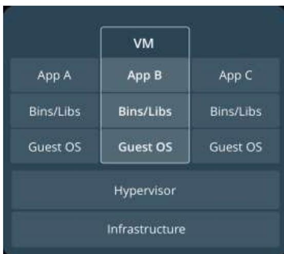
**Figura 2:** Diagrama de una máquina virtual
