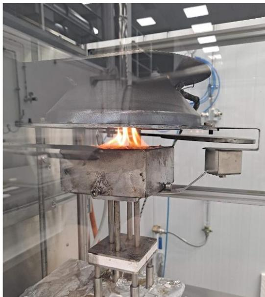
Figura 3. Disposición del cono calefactor y ejemplo de irradiación sobre muestra.
