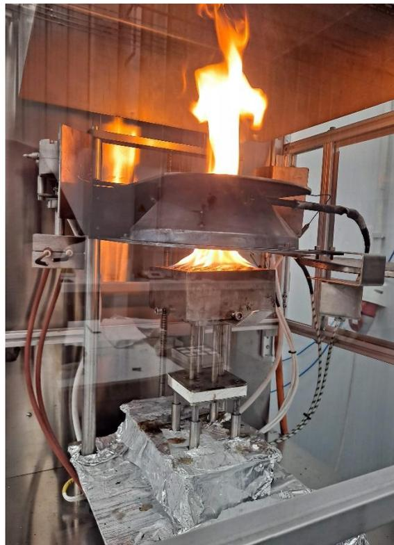
Figura 5. Probeta durante el ensayo de cono calorimétrico
