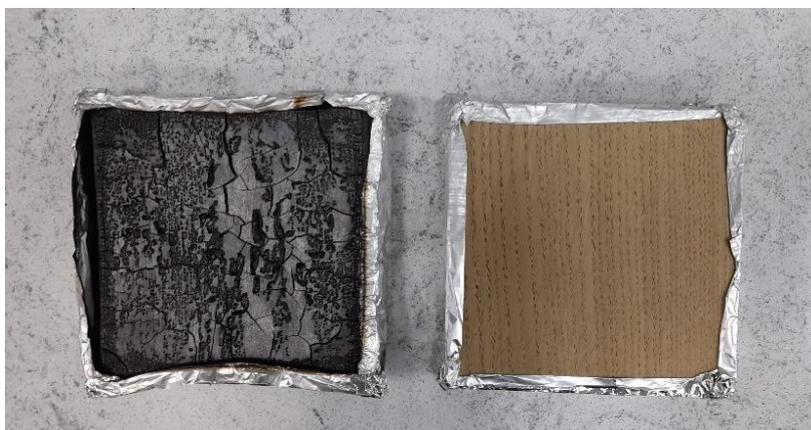
Figura 10. Aspecto muestra PFT-09 antes y después del cono calorimétrico.
