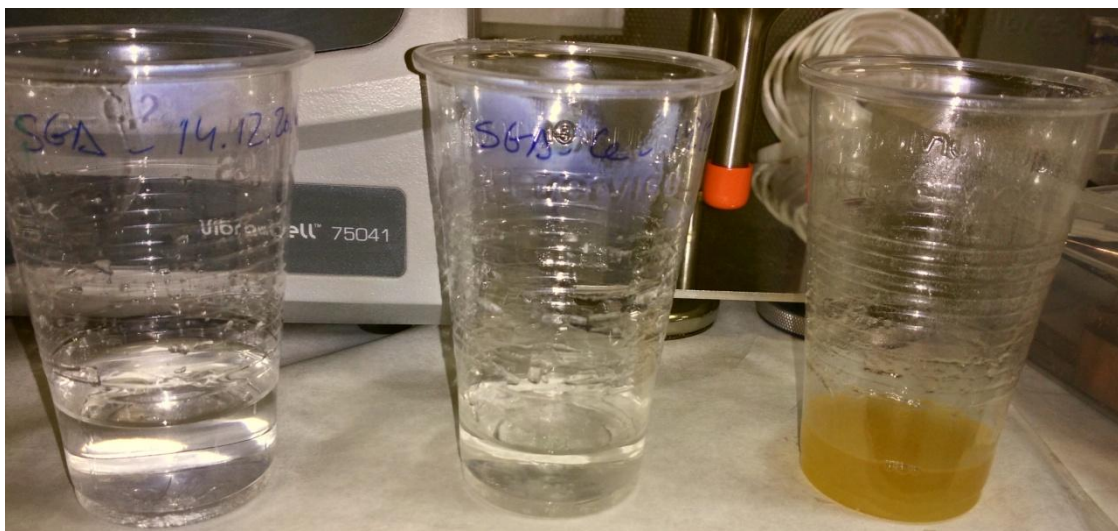
Figura 3. Aspecto visual de los sol-gel preparados. SGA (izquierda), SGA+Ce 3+ (centro), SGA+ Ce 3+ encapsulado (derecha).
