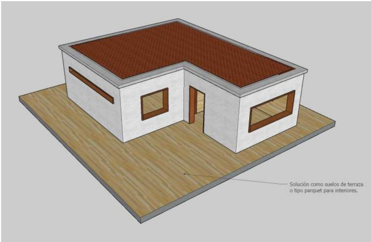
**Imagen 21. Edificación sencilla (vivienda unifamiliar de una planta) con paneles de INNOCOND para todos los suelos: parquet interior, el parquet exterior y suelo de la terraza techada**
