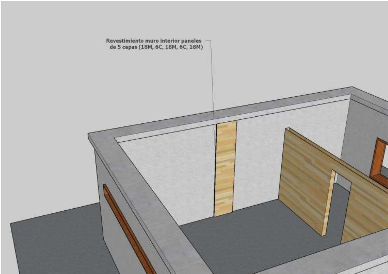
**Imagen 9. Ilustración 3D del uso de los paneles prefabricados de INNOCOND como revestimiento interior de fachada**
