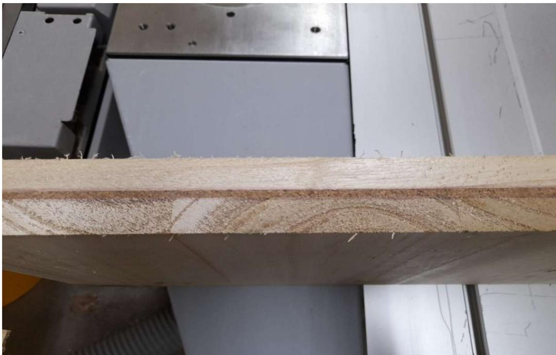
**Imagen 4. Detalle transversal del tablero contralaminado de paulownia de 3 capas desarrollado en INNOCOND**
