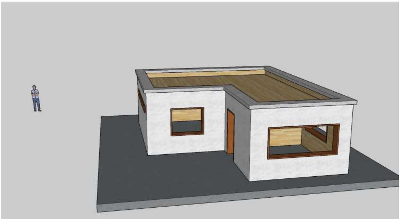
**Imagen 19. Edificación sencilla (vivienda unifamiliar de una planta) con paneles de INNOCOND para puertas, ventanas, tabiques interiores y falso techo para cubierta**
