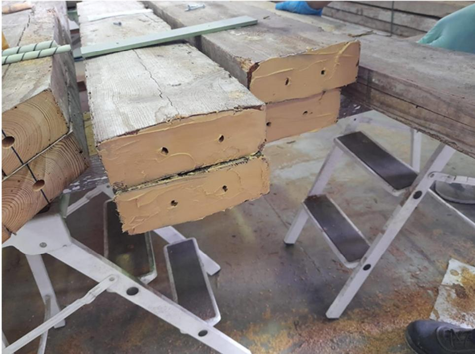
Figura 29. Impregnado con el adherente
