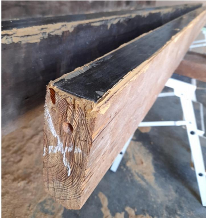
Figura 19. Resultado final con FRP solapado
