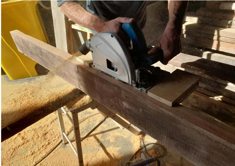
Figura 15. Detalle del corte de la sierra para el FRP incrustado
