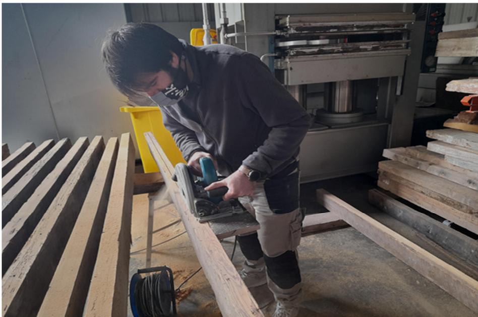
Figura 14. Ranurado con sierra de disco para el FRP incrustado
