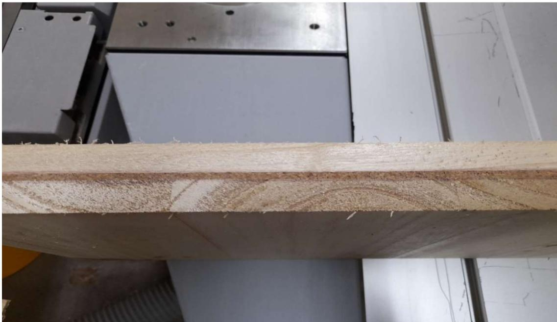
Figura 15. Ejemplo de muestra de madera-nuevo material lignocelulósico-madera, después de aserrarla (formulación final del NML y madera de paulownia). El aserrado no disgrega el NML seco ni arranca trozos de él; es un corte muy limpio. La adhesión del NML, una vez seco, a la madera es correcta y su espesor es uniforme.
