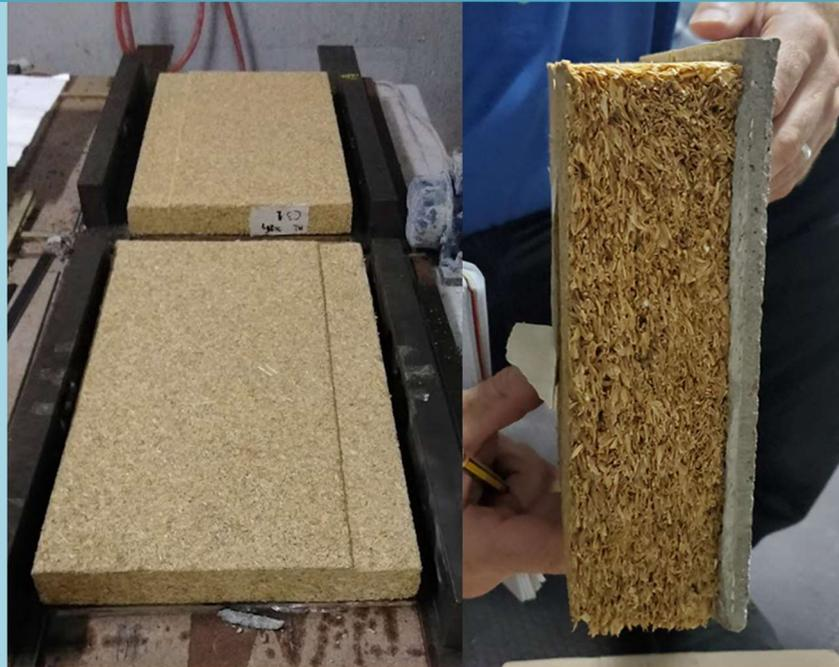
**Prototipo experimental de tablero aglomerado de cáscara de arroz adherido a una placa de hormigón. Fuente: AIDIMME**
