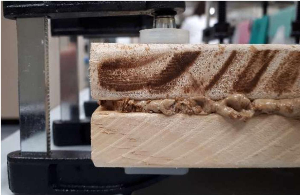
Figura 14. Ejemplo del nuevo material lignocelulósico (NML) entre dos muestras pequeñas de pino silvestre. El espesor del NML es de 5 mm; el del pino, 18 mm. En esta prueba, el secado fue en estufa a 50°C y la presión se ejerció mediante gatos.
