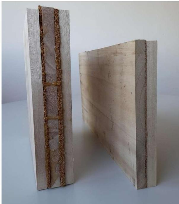
Figura 17. Ejemplo de dos de los prototipos finales (contralaminado de 5 capas con paulownia y el nuevo material lignocelulósico)
