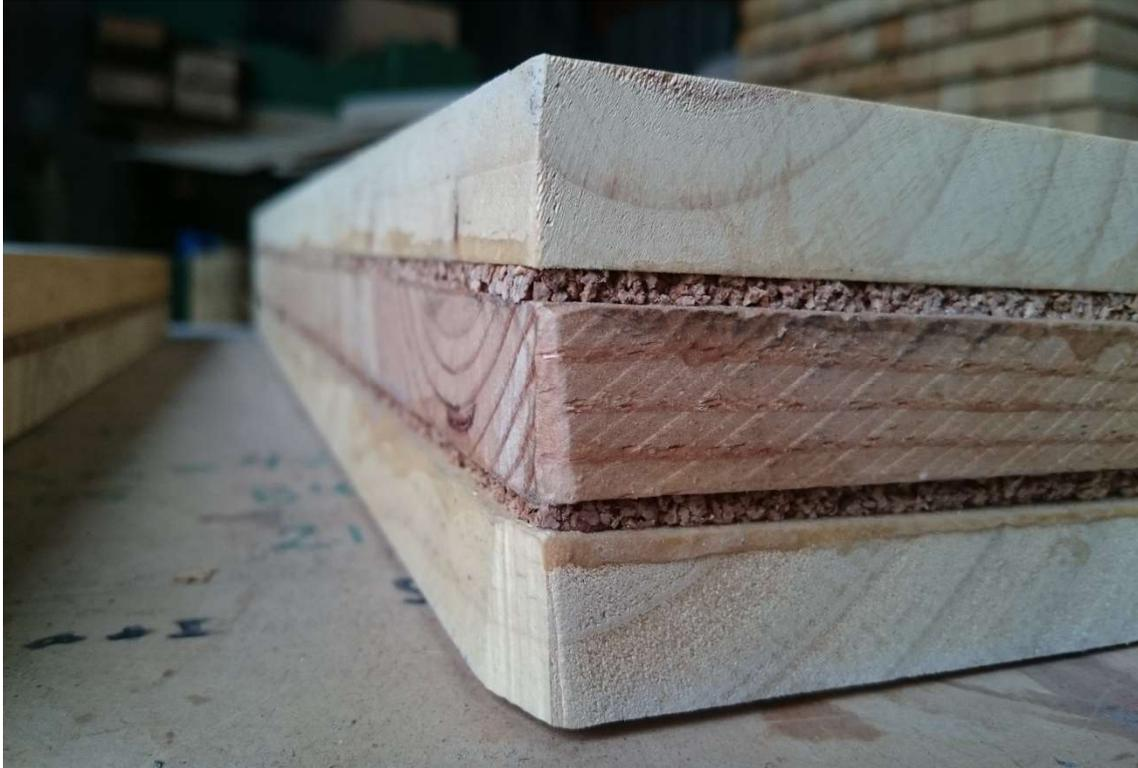
Figura 16. Ejemplo de uno de los prototipos finales (contralaminado de 5 capas con pino y el nuevo material lignocelulósico)
