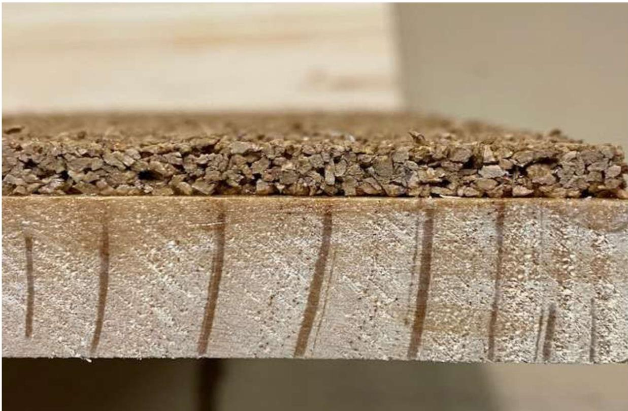
Figura 13. Ejemplo del nuevo material lignocelulósico (NML) sobre una muestra pequeña de pino silvestre. El espesor del NML es de 5 mm; el del pino, 18 mm.
