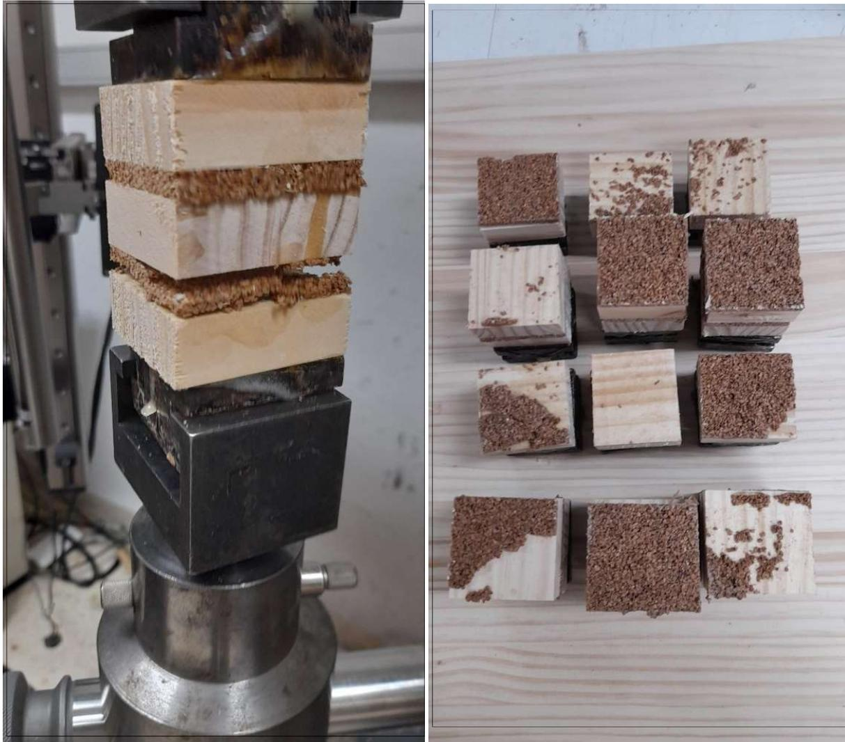
Figura 19. Izquierda: ensayo de resistencia a tracción perpendicular a las caras. Derecha: algunas muestras después del ensayo de resistencia a tracción perpendicular a las caras
