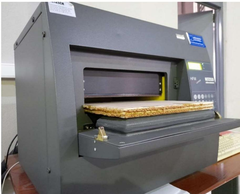
Figura 21. Introducción de una muestra de tablero contrachapado de paulownia y NML de 18 mm en el equipo de medida de la conductividad térmica
