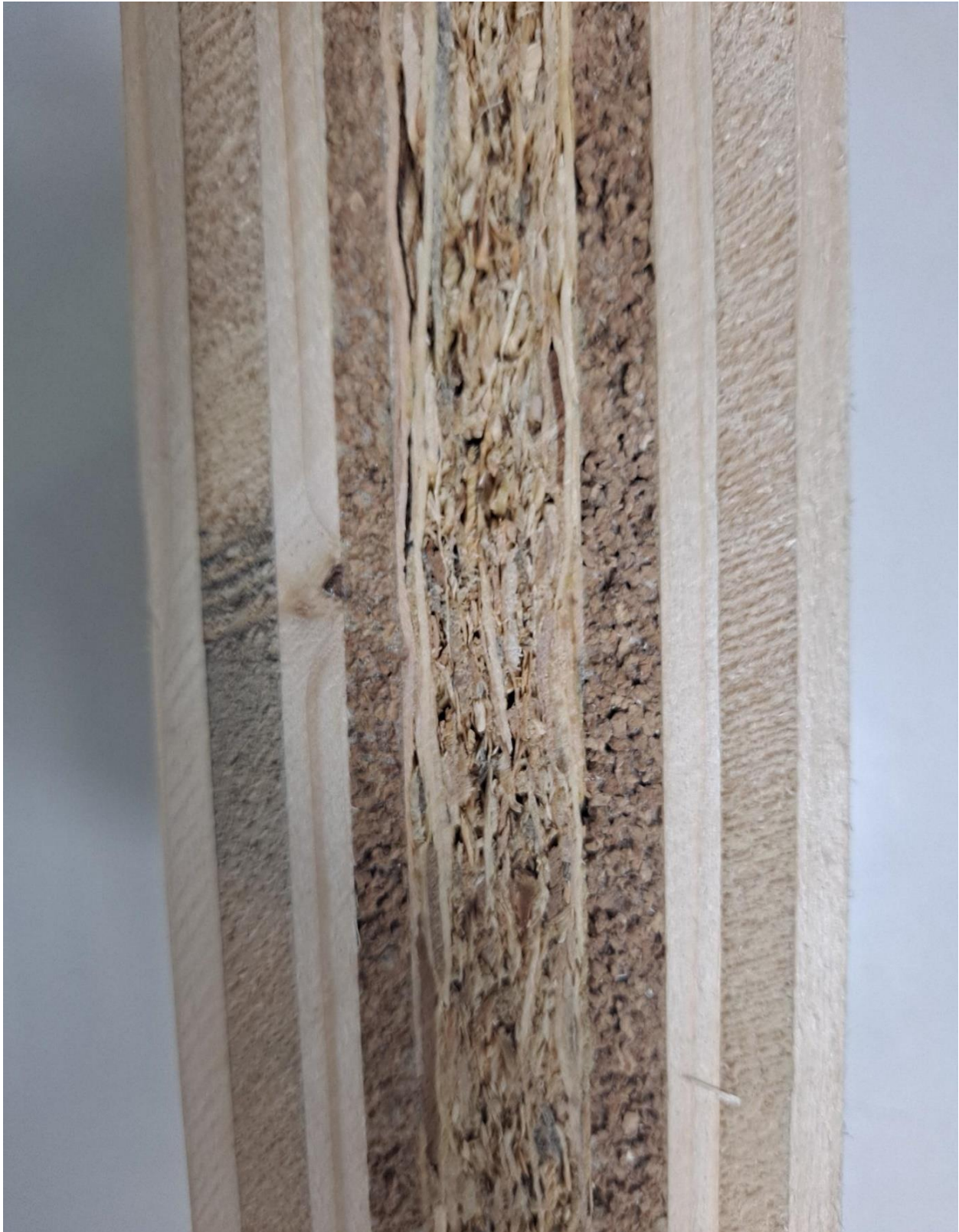
Imagen 1. Vista de detalle de un tablero IDSIATE 3, en la que pueden apreciarse dos capas del material lignocelulósico ultra-aislante.
