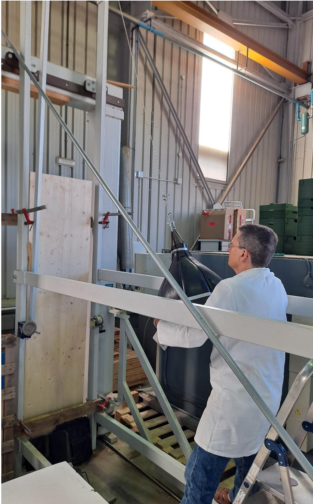
Imagen 4. Ensayo de impacto según el documento European Assessment Document 210005-00-0505 en un tablero IDSIATE 1.
