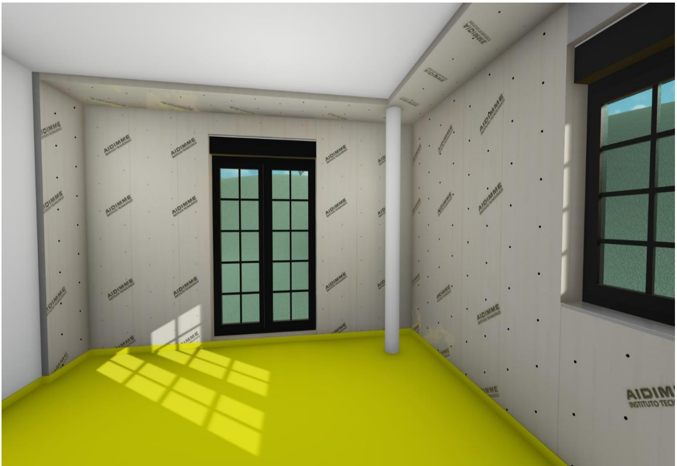
Imagen 16. Suelo con el aislamiento acústico contra el ruido de impactos.
