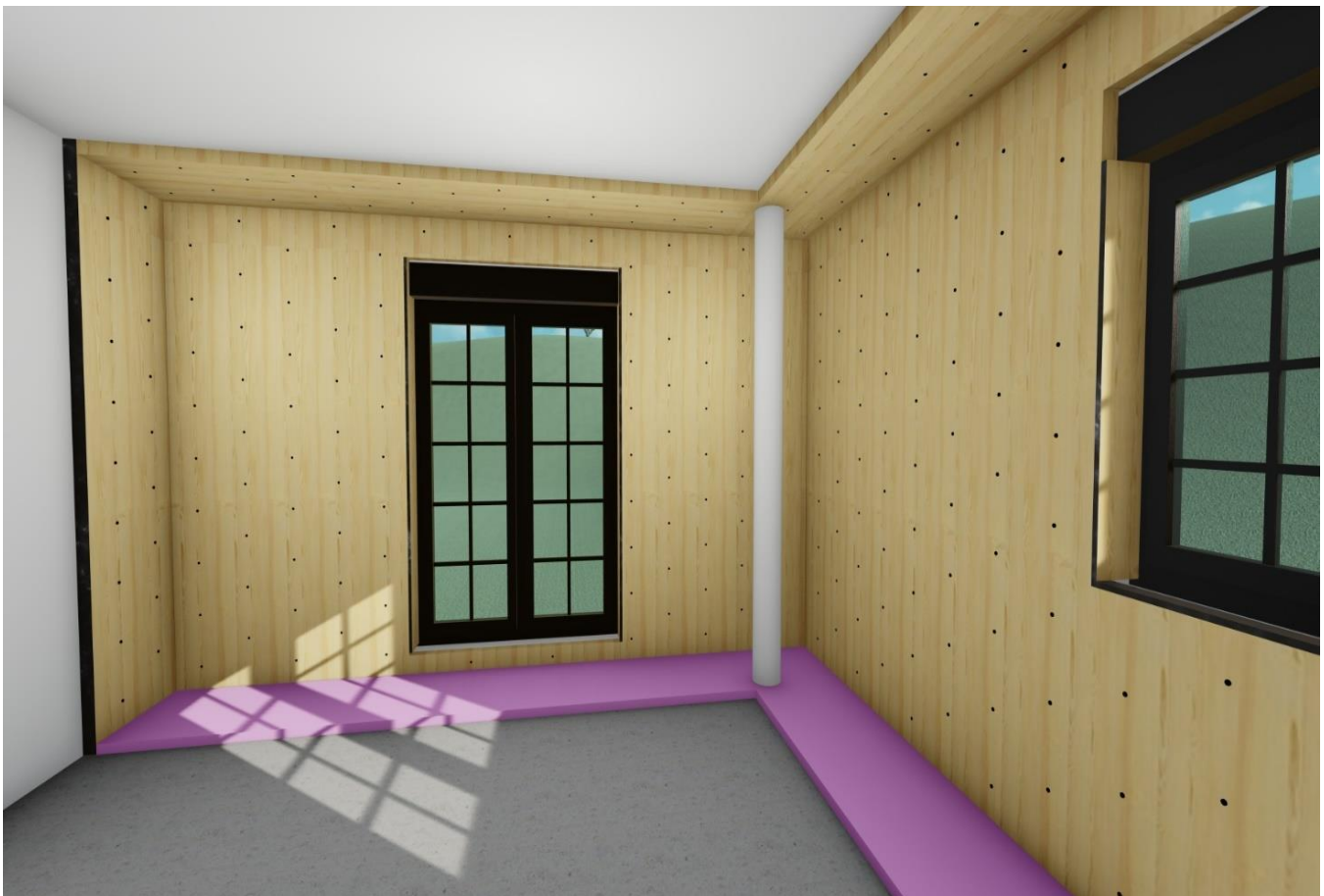
Imagen 6. Tableros IDSiate instalados sobre los muros y el techo mediante tornillos.
