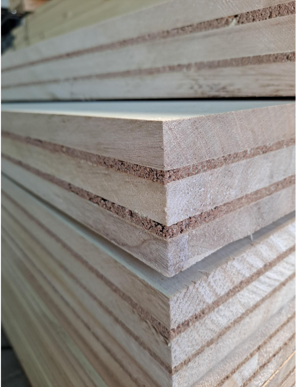
Imagen 2. Vista de detalle de varios tableros IDSIATE 2, en la que pueden apreciarse las capas del material lignocelulósico ultra-aislante.
