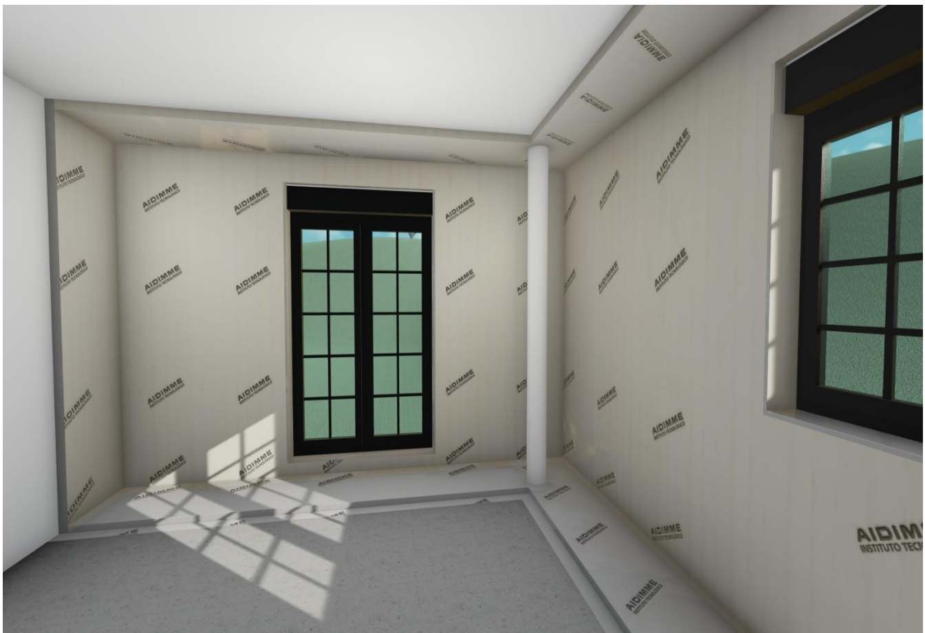
Imagen 11. Barrera de vapor con el logotipo de AIDIMME instalada sobre los tableros aislantes IDSIATE de los muros y del techo, así como sobre el aislante del suelo.
