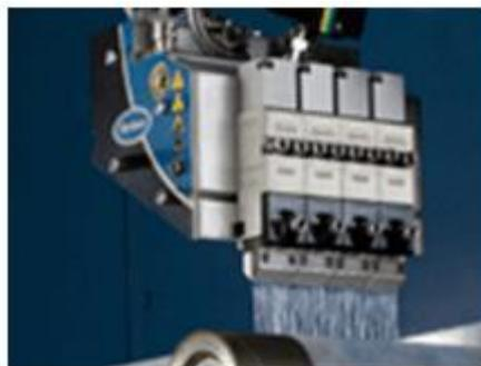
Figura 16. Planta aplicadora de hotmelts mediante sistema difusor de boquilla (slot die).
