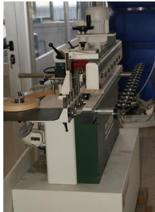
Figura 35. Equipo de laboratorio para el encolado de cantos.
