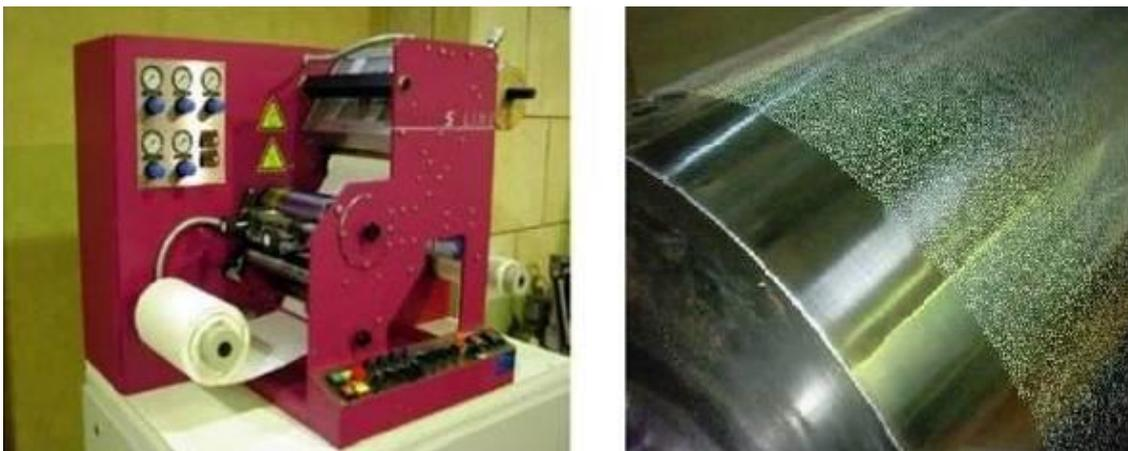
Figura 14. Planta aplicadora de hotmelts disponible en AITEX (izquierda) y cilindro aplicador grabado con puntos.
