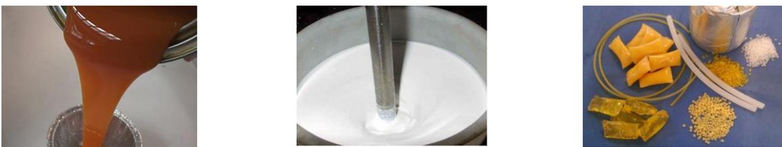
Figura 3. Adhesivos empleados en la industria del calzado: base disolvente, acuosa y hot melt.
