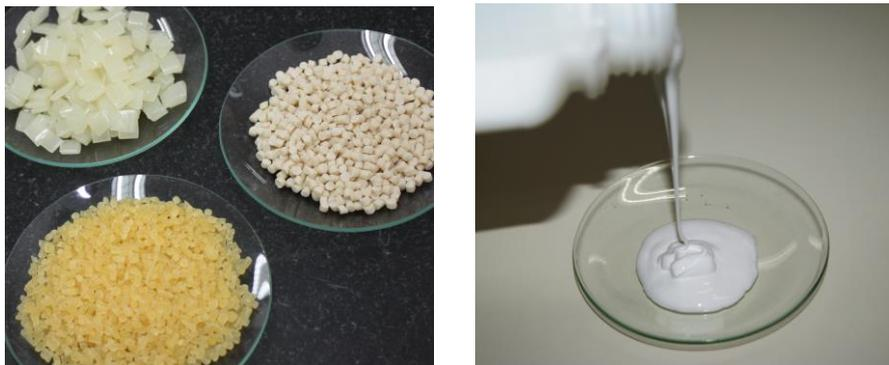
Figura 24. Adhesivos empleados en la industria del mobiliario y elementos de decoración: base acuosa y termofusible.
