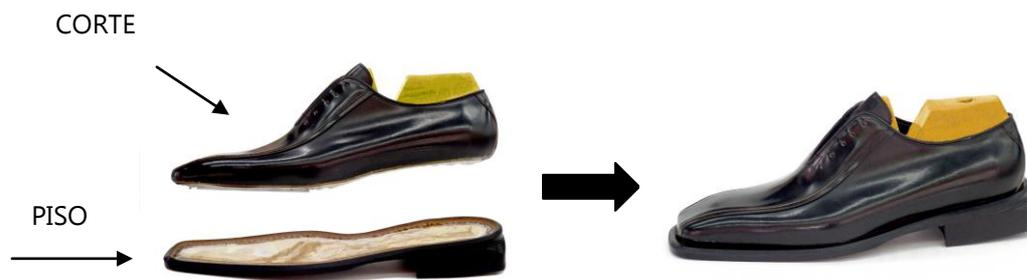
Figura 2. Unión corte-piso en calzado.
