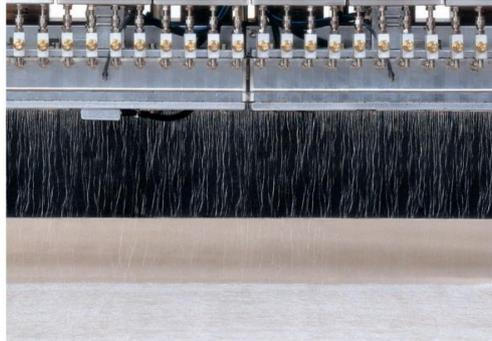
Figura 19. Dispositivo de sprayado de hotmelts y deposición sobre textil.
