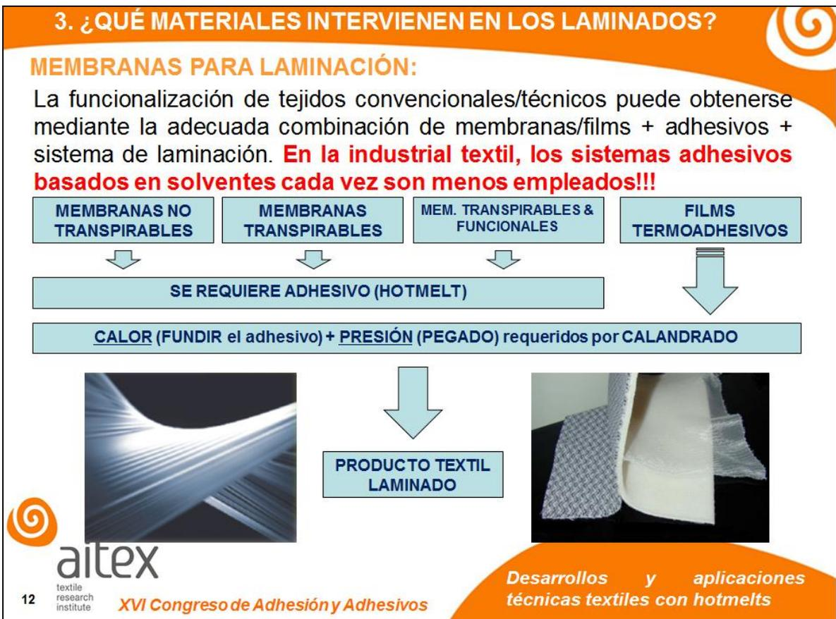
Figura 10. Combinaciones con materiales poliméricos en formato membrana/film que pueden obtenerse empleando adhesivos junto un textil.
