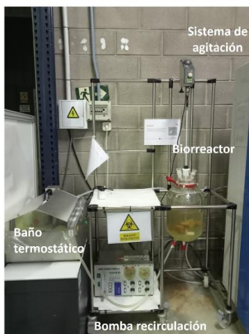
Montaje sistema biodegradación espumas de poliuretano flexibles
