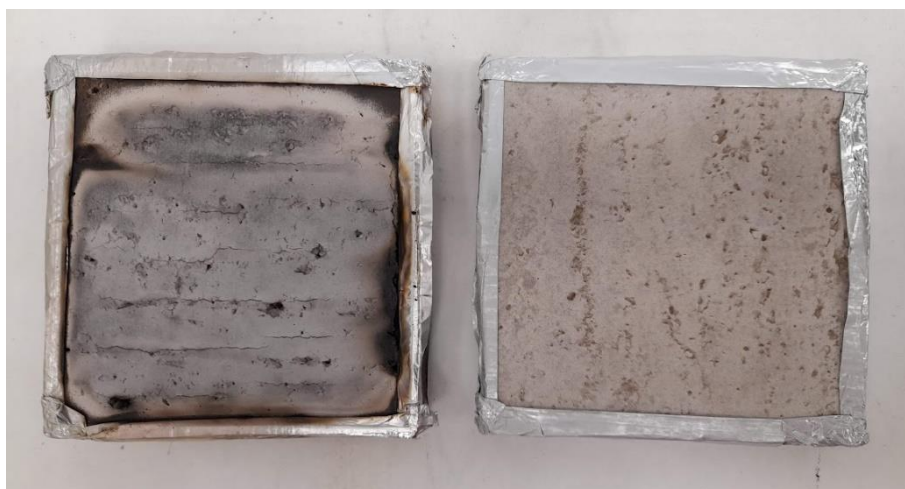
Figura 10. Aspecto muestra PROFOC-38 antes y después del cono calorimétrico
