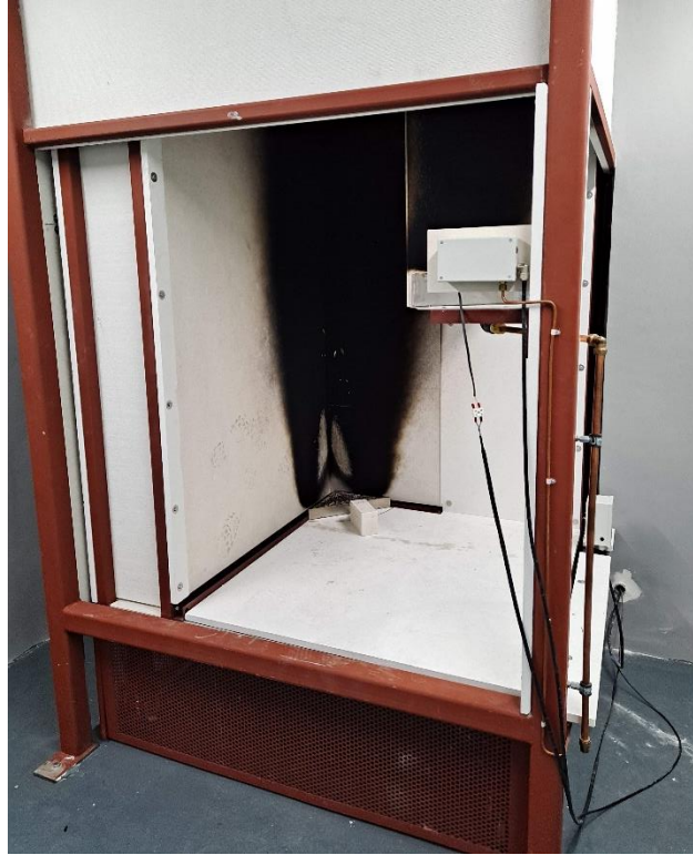
Figura 14. Imagen de la cabina de quemado del equipamiento SBI en instalaciones de AIDIMME
