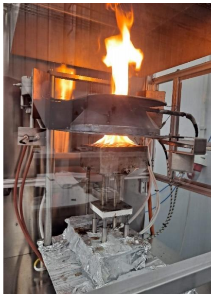
Ilustración 7. Probeta durante el ensayo de cono calorimétrico
