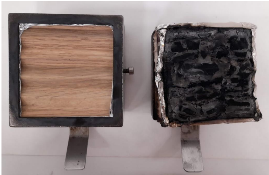
Figura 8. Aspecto muestra PROFOC-29 antes y después del cono calorimétrico
