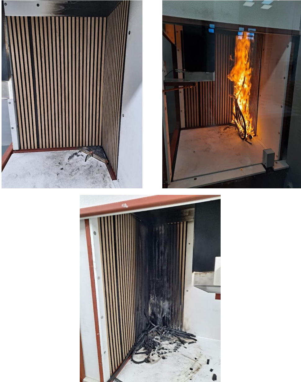
Figura 15. Muestra PROFOC-35 antes, durante y después del ensayo SBI
