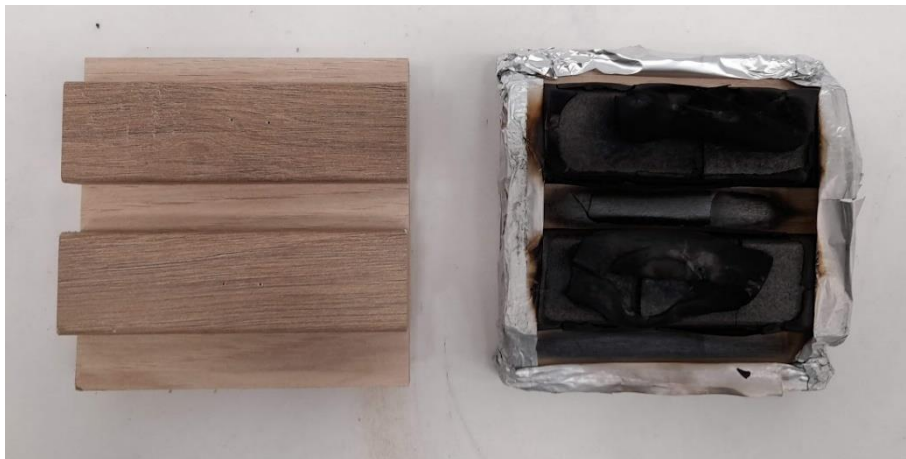
Figura 9. Aspecto muestra PROFOC-45 antes y después del cono calorimétrico
