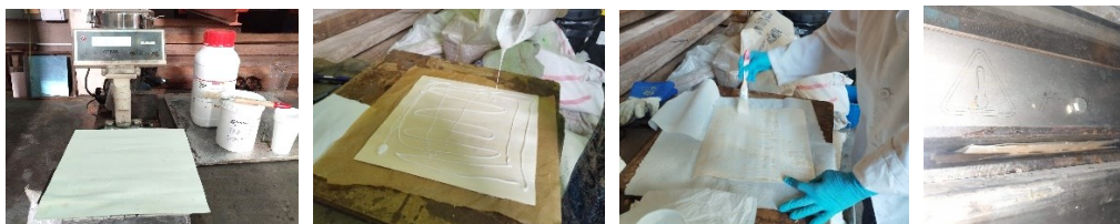
Figura 13.- Proceso de aplicación del adhesivo y prensado.
