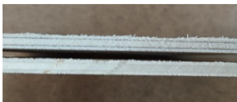
Figura 19.- Imagen de los bordes de los contrachapados fabricados en ARCHELA con adhesivo de PVAc con (arriba) y sin (abajo) lignina.
