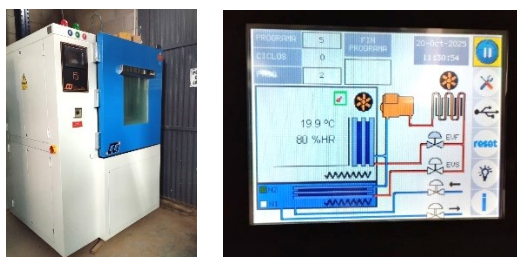
Figura 20.- Cámara climática de AIDIMME empleada para acondicionar a 20^\circ\text{C} y 80% HR las muestras de los contrachapados fabricados en ARCHELA para ensayo a esfuerzo cortante.
