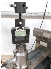
Figura 9.- Ejemplo de una de las muestras del proyecto en el dispositivo cardan en la máquina universal de ensayos.
