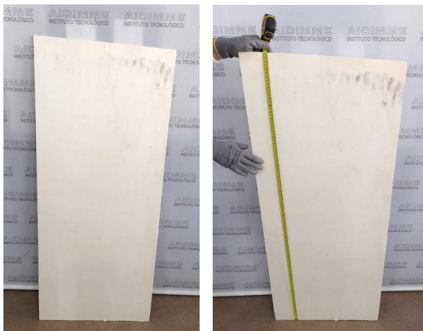
Figura 21.- Prototipo del tablero P-F6 realizado en las instalaciones de ARCHELA y cortado en AIDIMME.
