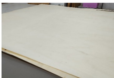
Figura 18.- Muestra final de uno de los contrachapados fabricados en la empresa colaboradora ARCHELA.
