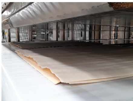
Figura 17.- Entrada a la prensa industrial de uno de los prototipos de contrachapados fabricados.
