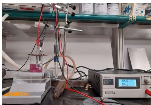
Figura 4. Izquierda; Montaje laboratorio ensayos electrolisis con material catódico en lámina. Derecha, aspecto licor antes y después de tratamiento lixiviación de material catódico en lámina en H 2 SO 4 2M.
