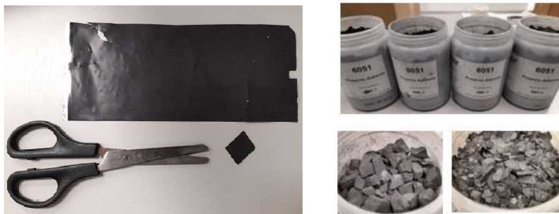
Figura 2. Material catódico en lámina (izda.) y formato black mass (drcha.)
