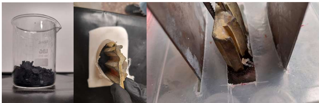
Figura 5. Izquierda; black mass a lixiviar, derecha; electrodo de Pb en saco del PP en contacto con black mass
