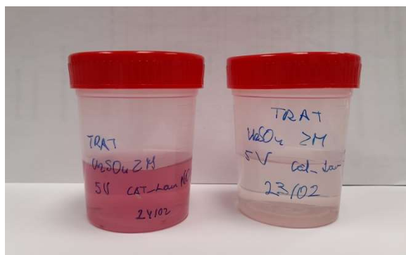
Figura 4. Izquierda; Montaje laboratorio ensayos electrolisis con material catódico en lámina. Derecha, aspecto licor antes y después de tratamiento lixiviación de material catódico en lámina en H 2 SO 4 2M.
