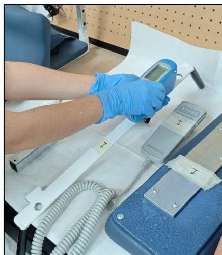
Ilustración 19 Medición del brillo especular tras la aplicación.
