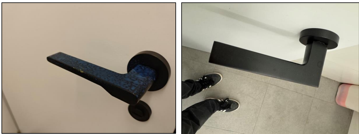
Ilustración 16 A la izquierda el recubrimiento todavía húmedo. A la derecha una vez seco. Empresa PALBOX INDUSTRIAL.
