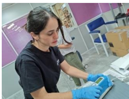
Ilustración 21 Muestras de plástico y metal recubiertas parcialmente y toma de datos del brillo especular.
