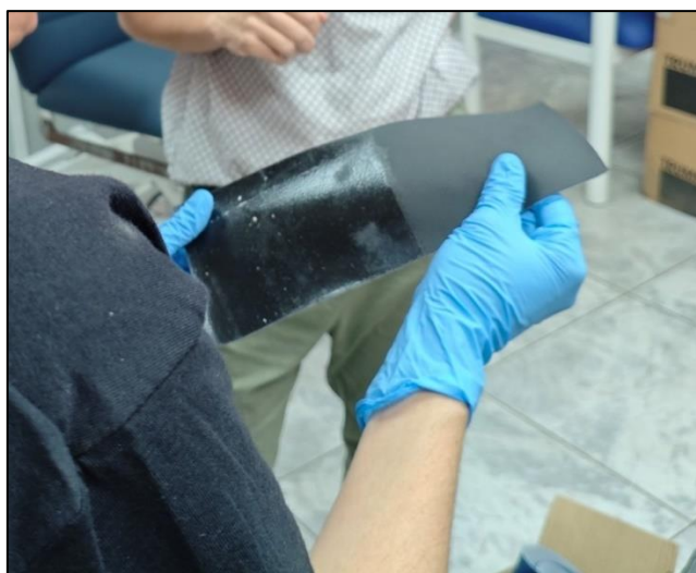
Ilustración 20 Muestra de polipiel en que se ha aplicado el recubrimiento en una parte.
