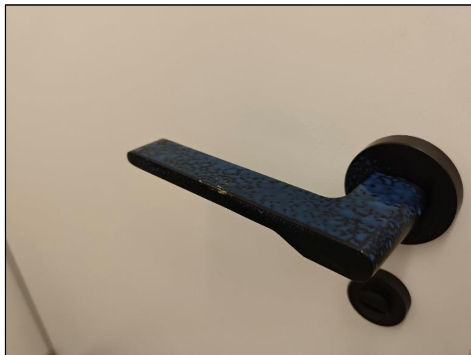
Ilustración 8 Maneta de puerta con el recubrimiento ya aplicado y todavía húmedo.
