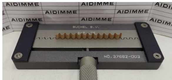
Fotografía 17.- CCT perfil onda B
