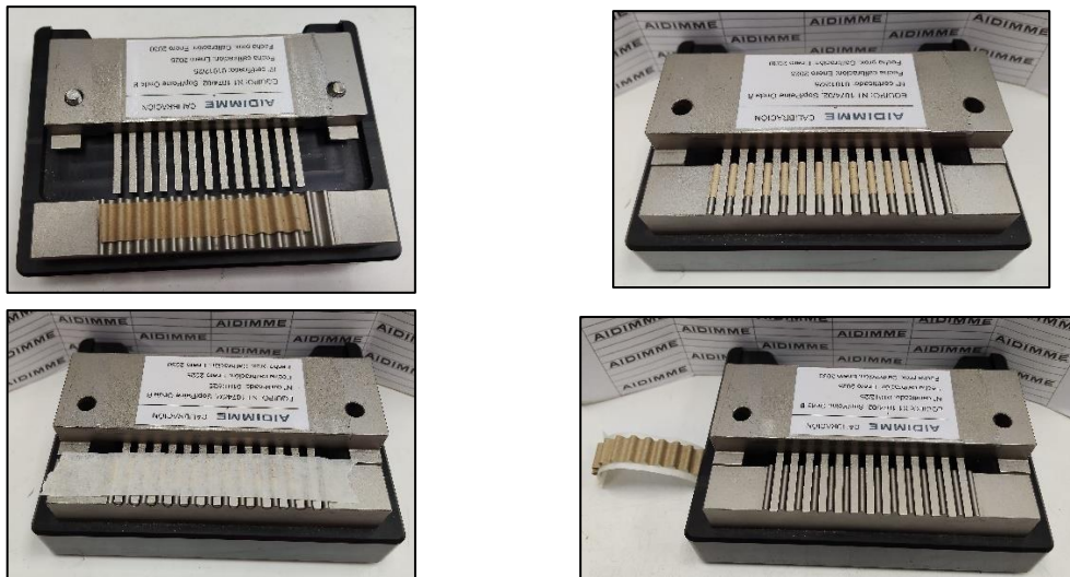
Fotografías 10 a 15.- Preparación de probetas CMT perfil onda B
