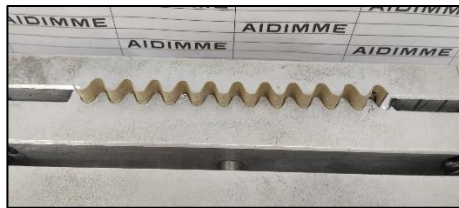
Fotografías 2 y 3.- Prueba de CCT, perfil de onda A y perfil de onda B
