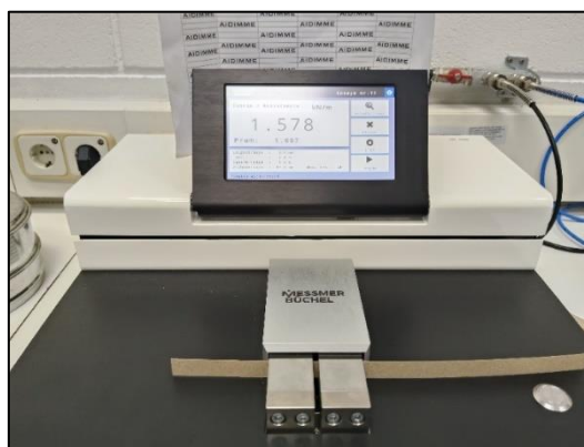
Fotografía 19.- Prueba de S-Test
