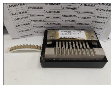
Fotografías 4 a 9.- Preparación de probetas CMT perfil onda A
