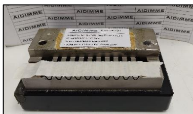
Fotografías 4 a 9.- Preparación de probetas CMT perfil onda A
