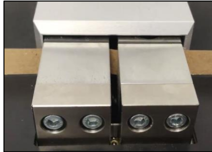
Fotografía 20.- Detalle de las mordazas de S-Test
