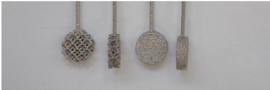
**Figura 2.** Detalle de las probetas de Ti6Al4V (macizas y porosas) con cilindro para conexión; probetas obtenidas mediante fabricación aditiva.
