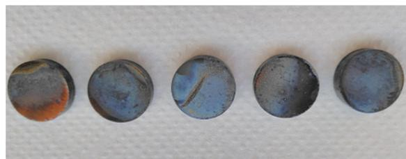
**Figura 22.** Imagen de probetas de Ti6Al4V recubiertas con hidroxiapatita mesoporosa.
