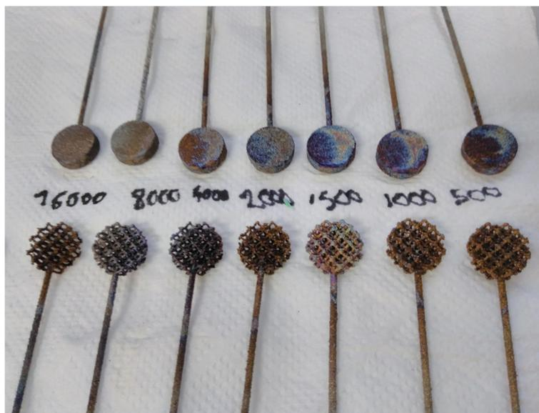
**Figura 25.** Probetas de Ti6Al4V obtenidas mediante fabricación aditiva y anodizadas con diferentes tiempos de anodizado (500 s, 1000 s, 1500 s, 2000 s, 4000 s, 8000 s, 16000 s) a 10 V y recubiertas con nanopartículas de Ag obtenidas mediante la reducción de  $[\text{Ag}(\text{NH}_3)_2]^+$  empleando  $\text{NaBH}_4$  como reductor.
