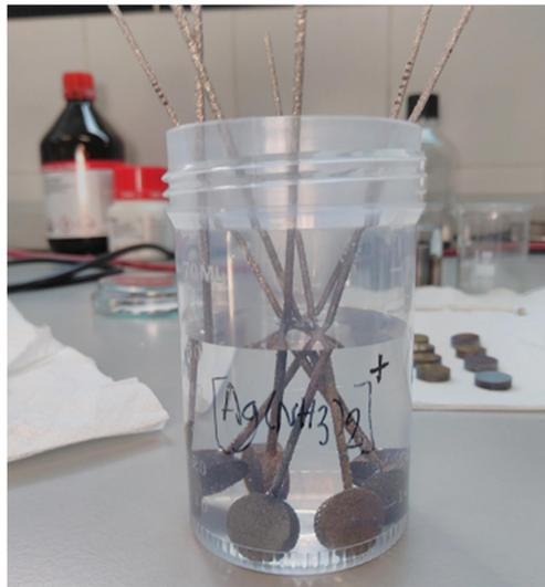
**Figura 23.** Proceso de recubrimiento con  $[Ag(NH_3)_2]^+$  de probetas de Ti6Al4V obtenidas mediante fabricación aditiva.
