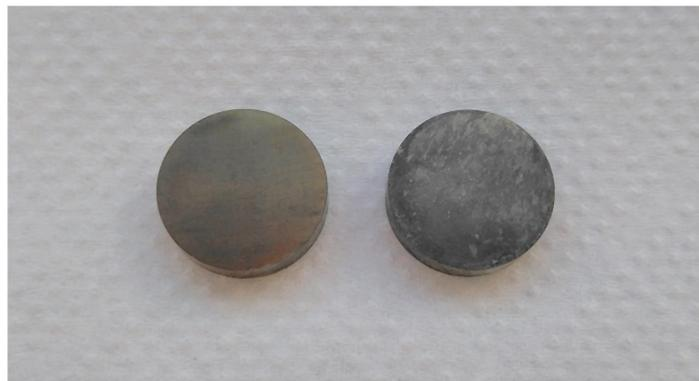
**Figura 27.** Probetas de Ti6Al4V recubiertas con sílica mesoporosa (derecha) y recubierta con sílica mesoporosa con nanopartículas de Ag obtenidas mediante la adsorción de  $[Ag(NH_3)_2]^+$  durante 30 min y posterior reducción térmica a 550 °C durante 2h.
