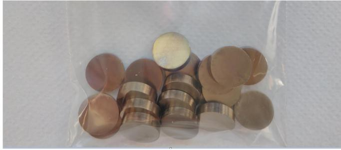
**Figura 19.** Imagen de probetas de Ti6Al4V recubiertas con un recubrimiento mesoestructurado de sol-gel de Si.
