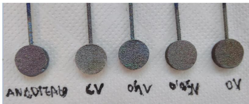
**Figura 33.** De izquierda a derecha; imágenes de probetas de Ti6Al4V: anodizada, anodizada+Ag NPs por voltametría cíclica, síntesis mediante salto potencioestático a 0.1 V, síntesis mediante salto potencioestático a 0.05 V, síntesis mediante salto potencioestático a 0 V.
