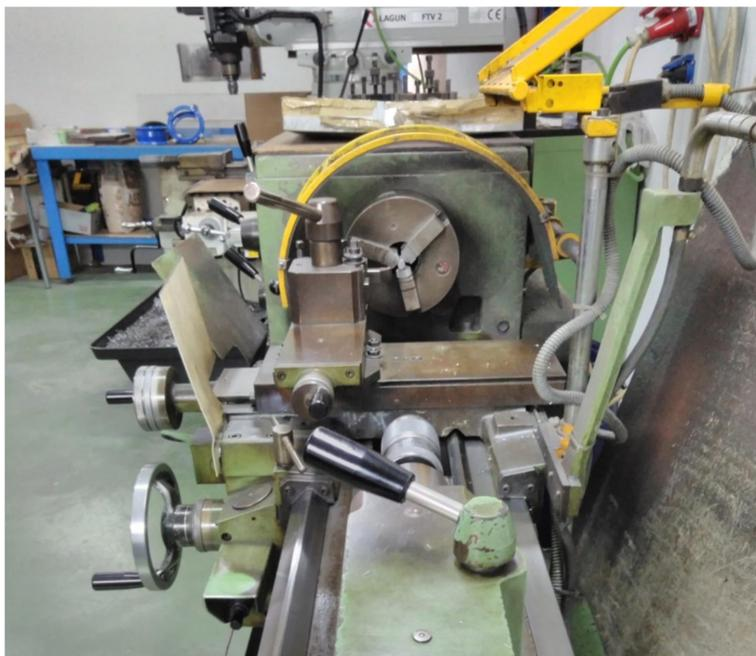
**Figura 4.** Operación de mecanizado de las barras de Ti empleando un torno.
