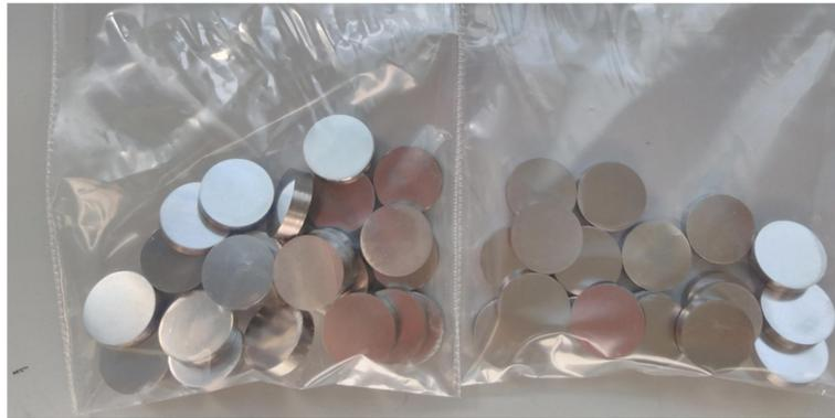
**Figura 7.** Probetas de Ti6Al4V obtenidas tras cortar las muestras y realizar un pulido.
