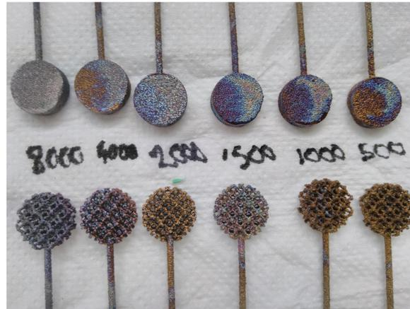
**Figura 16.** Fotos de las probetas de Ti6Al4V obtenidas mediante fabricación aditiva (macizas y porosas) y anodizadas durante 500 s, 1000 s, 1500 s, 2000 s, 4000 s y 8000 s.
