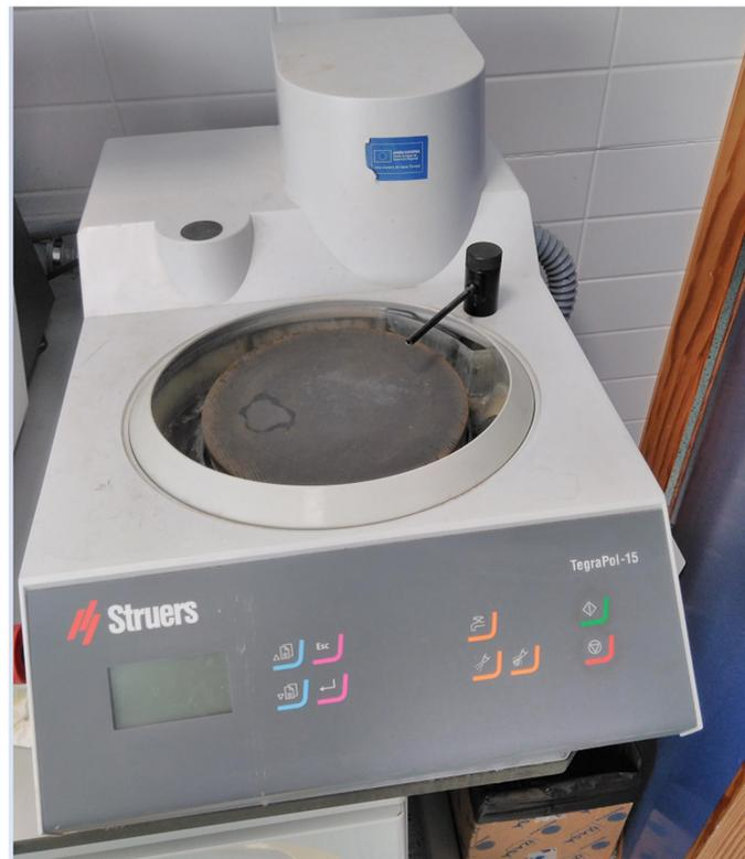
**Figura 8.** Pulidora empleada para pulir las muestras de Ti6Al4V.
