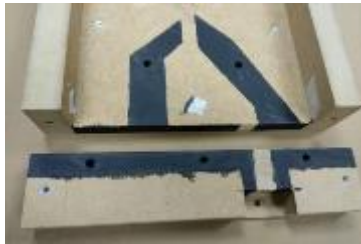
Detalle de cómo quedan las piezas tras la aplicación de la pintura conductora
