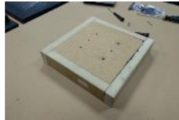
Detalle de cómo quedan las piezas tras la aplicación de la pintura conductora
