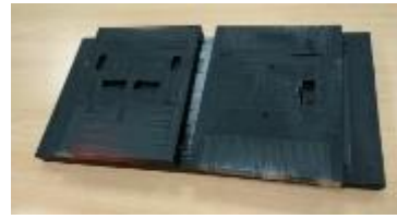
Detalle de cómo quedan las piezas tras la aplicación de la pintura conductora
