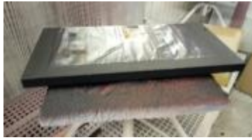
Detalle de cómo quedan las piezas tras la aplicación de la pintura conductora
