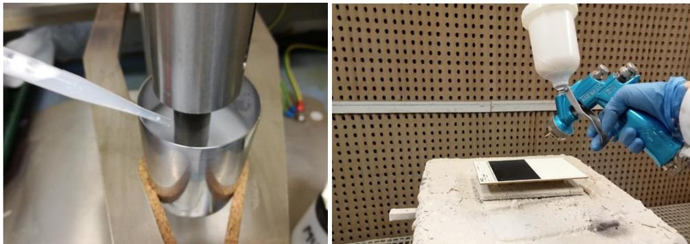
*Proceso de incorporación de las sustancias activas biocidas en recubrimientos poliméricos*
