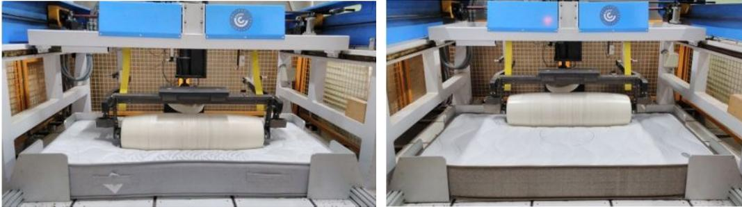
Figura 12: Preacondicionamiento de los colchones durante 100 ciclos.
