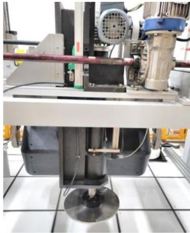
*Figura 17: Pletina y equipo para la obtención de la tasa de firmeza según la norma ASTM F1566-14.*
