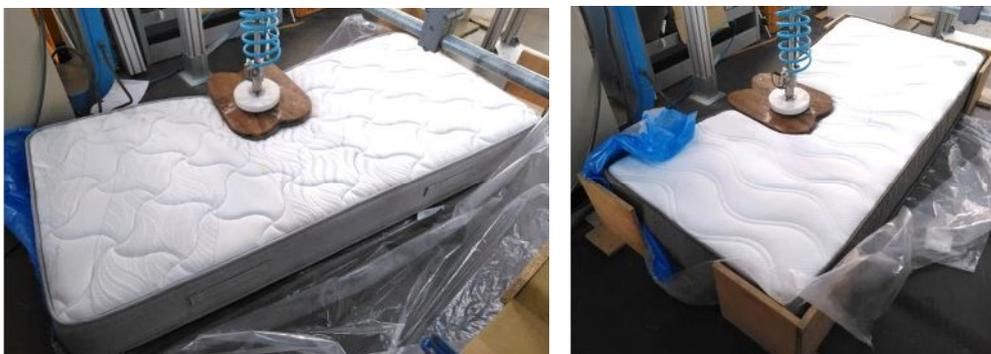
Figura 16: Aplicación del indentor en el lateral de los colchones MU y ES.
