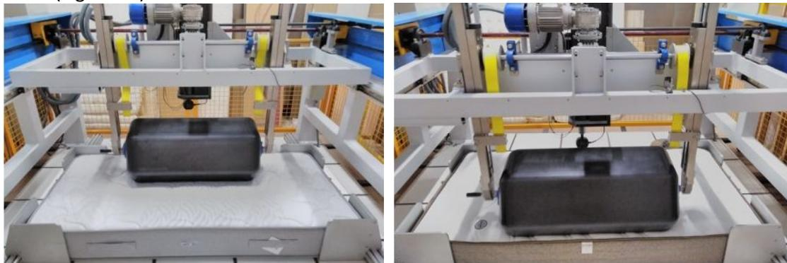
*Figura 20: Realización del test de durabilidad de los colchones MU y ES, según la norma ASTM F1566-14.*
