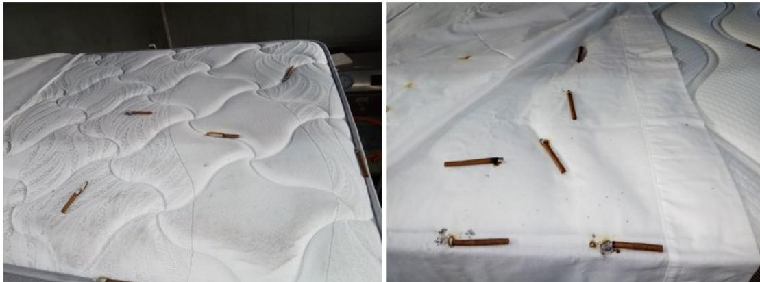
*Figura 11: Realización del análisis en los colchones MU y ES de resistencia a la ignición de los colchones según la norma americana 16 CFR-1632*
