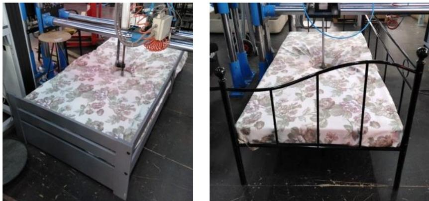
*Figura 36: Realización del estudio de carga estática vertical en la base de la camas MA y ME, según ISO 19833:2018.*
