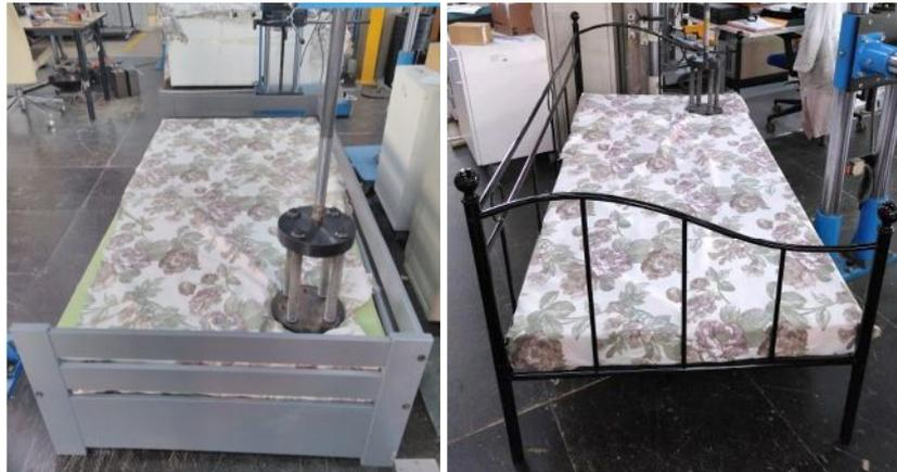
*Figura 41: Realización del estudio de impacto vertical de las Camas MA y ME según ISO 19833:2018.*
