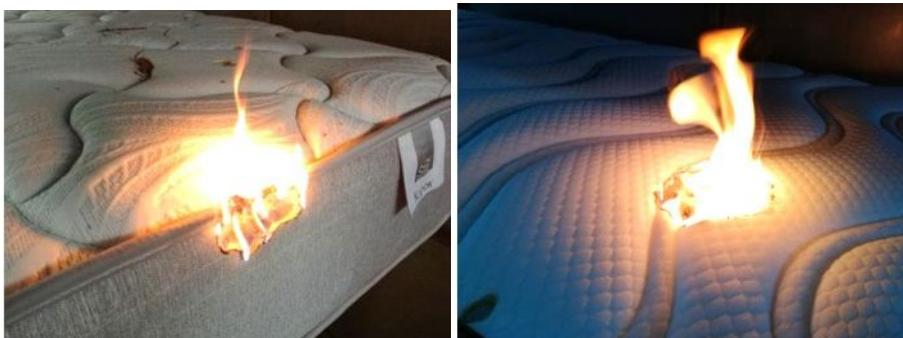
*Figura 8: Realización de la norma UNE-EN 597 con llama de gas en la muestra colchón MU y ES.*
