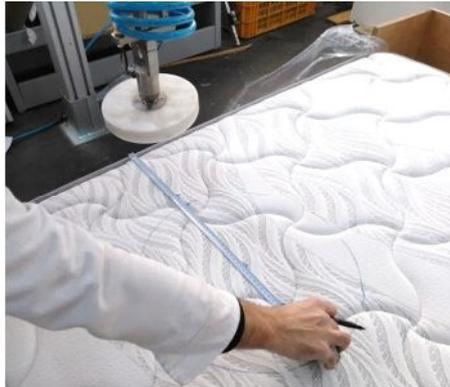
Figura 14: Ejemplo de la medición para la correcta colocación del indentor sobre el lateral del colchón MU según la norma UNE EN 1957\_2013.
