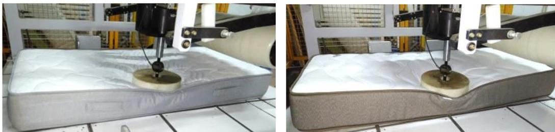
Figura 15: Medición de la altura y la dureza a los 100 ciclos en el lateral de ambos colchones.
