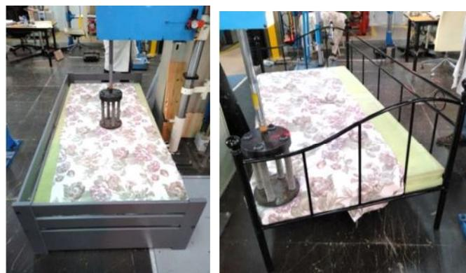
Figura 32: Realización del impacto vertical a las Camas MA y ME, según UNE EN 1725\_1998.
