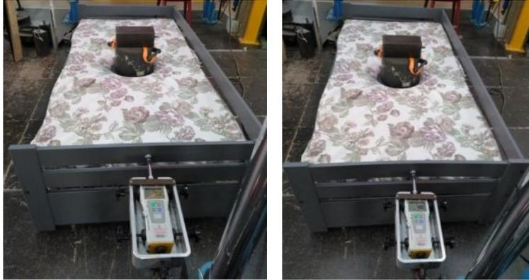
*Figura 37: Realización del estudio de carga estática horizontal (300 N y 400 N) a la Cama MA con cabezal de una anchura  $\leq 1200$  mm y altura  $\leq 300$  mm según ISO 19833:2018.*
