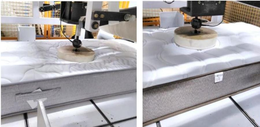
Figura 13: Medición de la altura y la dureza a los 100 ciclos en ambos colchones.
