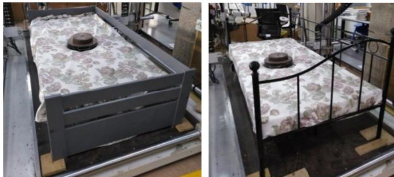
*Figura 40: Realización del estudio de durabilidad horizontal del marco de las Camas MA y ME según ISO 19833:2018.*
