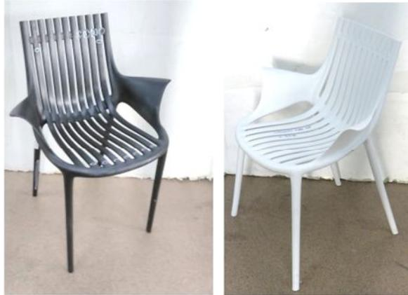
*Figura 50: Ejemplo de modelo de silla inicial a la izquierda y modelo de silla redimensionado para mejorar el vuelco lateral en asientos con brazos a la derecha.*
