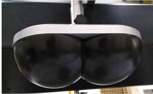
*Figura 25: Pletina Cornell utilizada para el estudio de la retención de la firmeza y deformación de la superficie según la norma ASTM F1566-14.*
