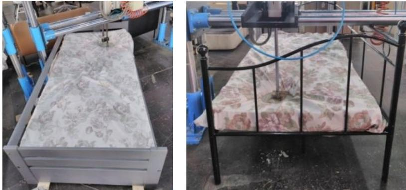
*Figura 39: Realización del estudio de durabilidad vertical de la base de las camas MA y ME, según ISO 19833:2018.*
