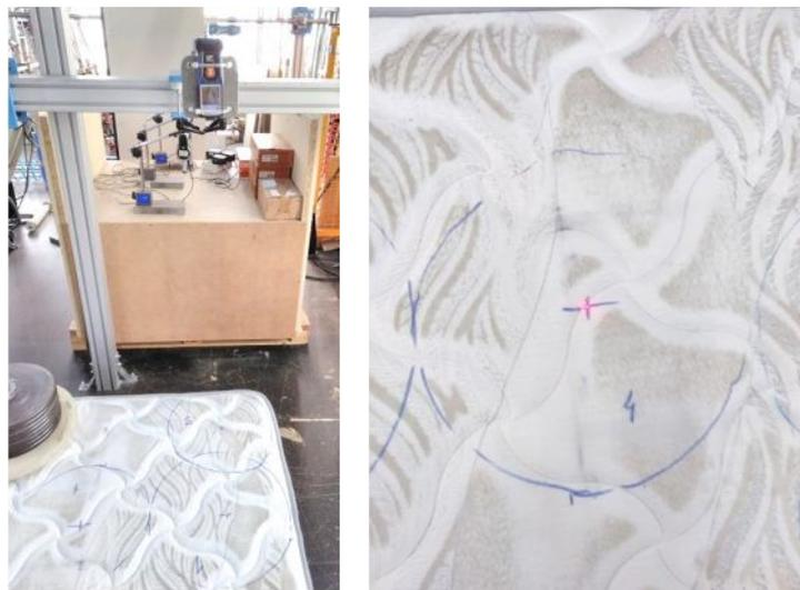
*Figura 22: Montaje del ensayo de impacto con el láser de medición. En ambas imágenes el láser se encuentra midiendo la distancia al punto "4".*
