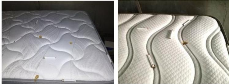
*Figura 7: Realización de la norma UNE-EN 597 con cigarrillo en combustión en la muestra colchón MU y ES.*
