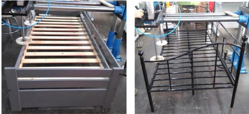
*Figura 35: Realización del estudio de carga estática vertical del lateral a las Camas MA y ME según UNE EN 1725\_1998.*
