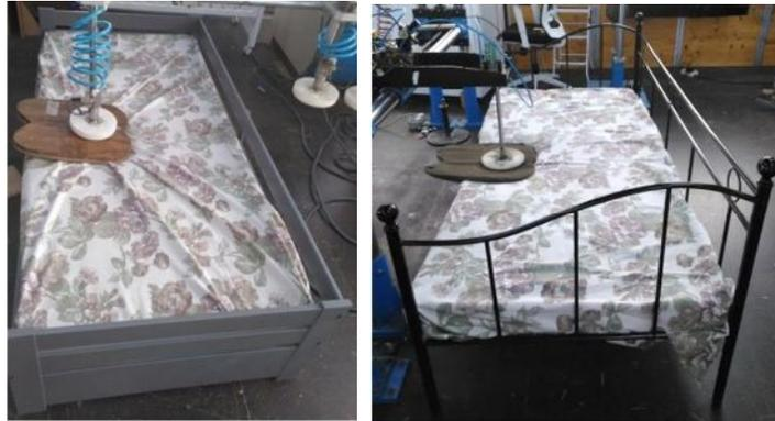
*Figura 33: Realización de la durabilidad lateral a las Camas MA y ME, según UNE EN 1725\_1998.*
