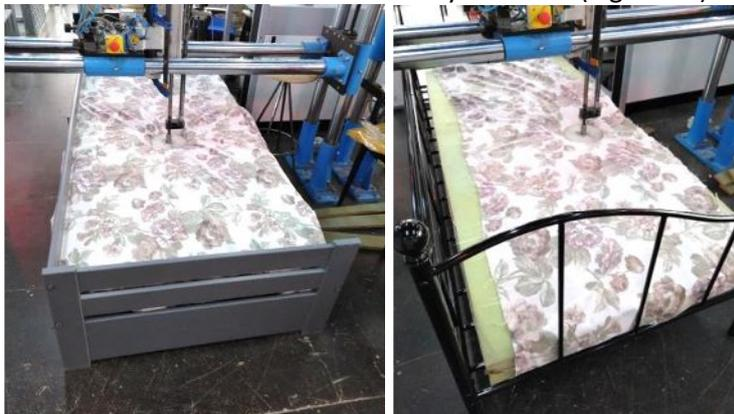
*Figura 34: Realización del estudio de carga estática vertical a las Camas MA y ME, según UNE EN 1725\_1998.*
