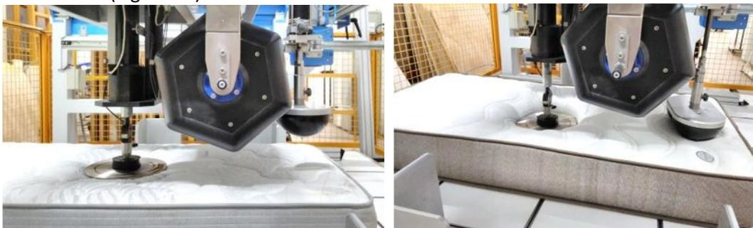
*Figura 27: Registro de la curva de deflexión de la carga en el colchón MU y ES según la norma ASTM F1566-14.*
