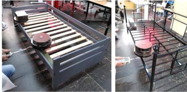
Figura 30: Realización análisis estabilidad a las Camas MA y ME, según UNE EN 1725\_1998.
