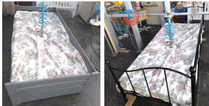
Figura 31: Realización análisis de durabilidad a las Camas MA y ME, según UNE EN 1725\_1998.
