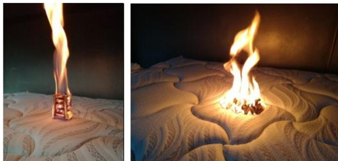
Figura 10: Imágenes de la aplicación de la norma BS 6807:2006 con la pira 5 en el colchón MU.
