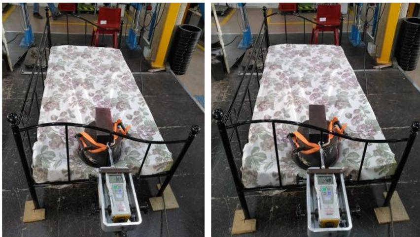
*Figura 38: Realización del estudio de carga estática horizontal (300 N y 400 N) a la Cama ME con cabezal de una anchura  $\leq 1200$  mm y altura  $\geq 300$  mm según ISO 19833:2018.*
