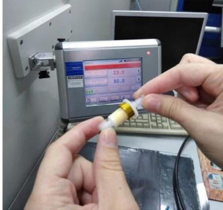
Figura 6: Cartucho para determinación de formaldehído con sílica gel recubierta de DNPH.
