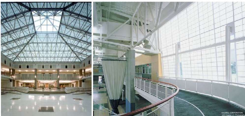
Imagen 6. Dos ejemplos de aislamiento mediante aerogel traslúcido como una solución de elevado aislamiento para luz diurna. FUENTE: Aerogel insulation for building applications: A state-of-the-art review (Baetens, Jelle y Gustavsen, 2011)
