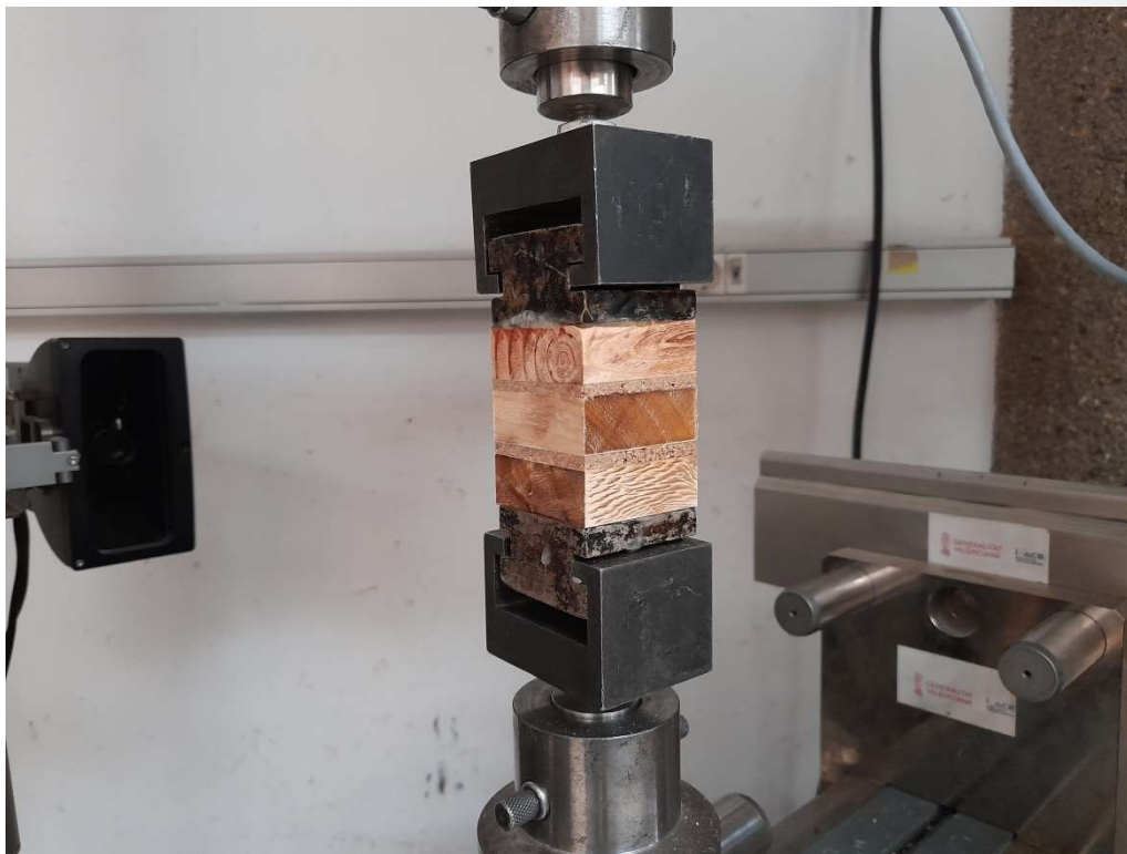
Imagen 16. Ensayo mecánico de tracción perpendicular a las caras en otro prototipo de los materiales innovadores desarrollados en INNOCOND.
