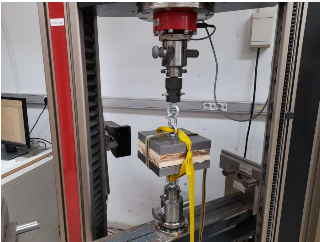
Imagen 15. Ensayo mecánico de tracción perpendicular a las caras en un prototipo de los materiales innovadores desarrollados en INNOCOND.
