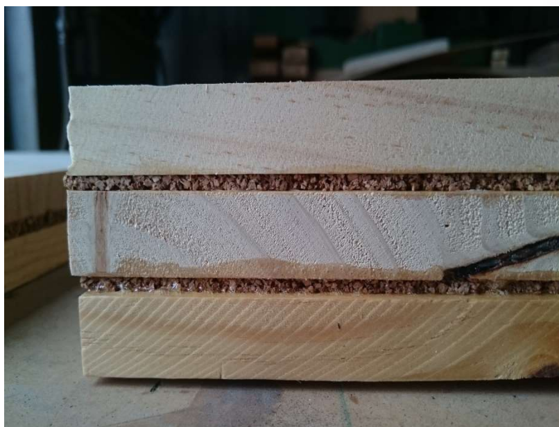
Imagen 13. Prototipo preliminar de uno de los materiales innovadores desarrollados en INNOCOND (tablero contralaminado de 3 capas de madera y 2 del nuevo material lignocelulósico).
