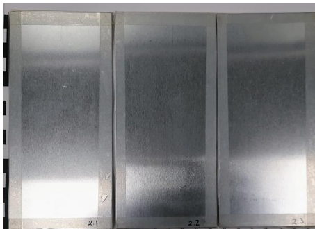
Figura 25. Muestras de zinc antes del ensayo de corrosión acelerada.
