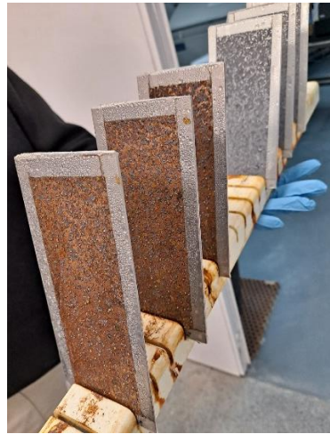
Figura 26. Probetas de acero (delante) y zinc (detrás) al finalizar ciclos de corrosión.
