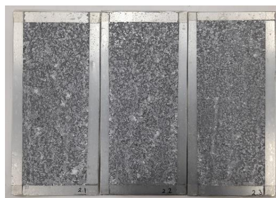
Figura 28. Probetas de zinc sin limpiar tras 3 ciclos de corrosión acelerada.
