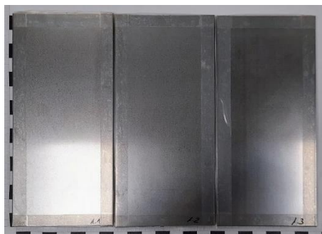
Figura 24. Muestras de acero antes del ensayo de corrosión acelerada.
