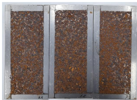
Figura 27. Probetas de acero sin limpiar tras 3 ciclos de corrosión acelerada.
