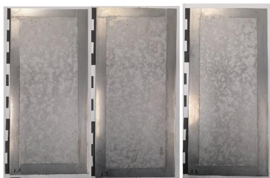
Figura 29. Probeta de acero limpia tras 3 ciclos de corrosión.
