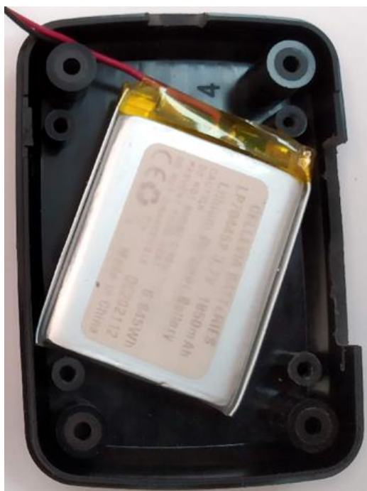
Imagen 24. Vista inferior del nuevo módulo DIPP_WIFI encapsulado en una caja de plástico.
