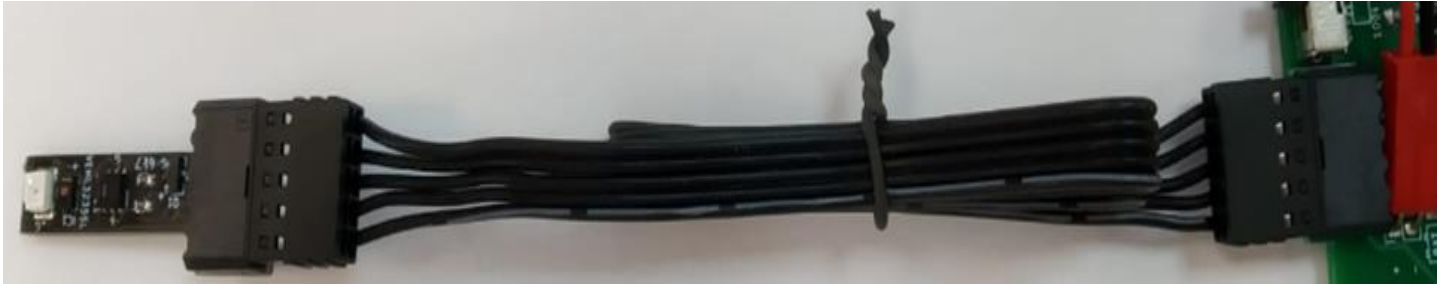
Imagen 27. Bus I2C y conectores entre DIPP_SENS Y DIPP_WIFI
