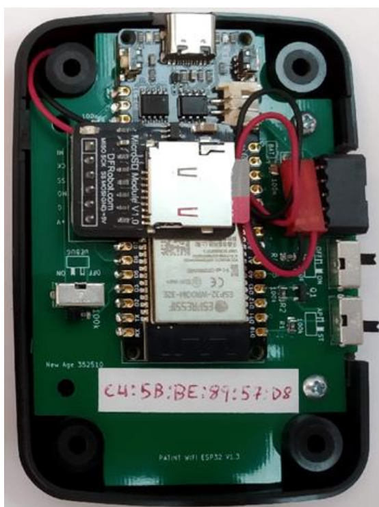
Imagen 25. Vista superior del nuevo módulo DIPP_WIFI encapsulado en una caja de plástico.
