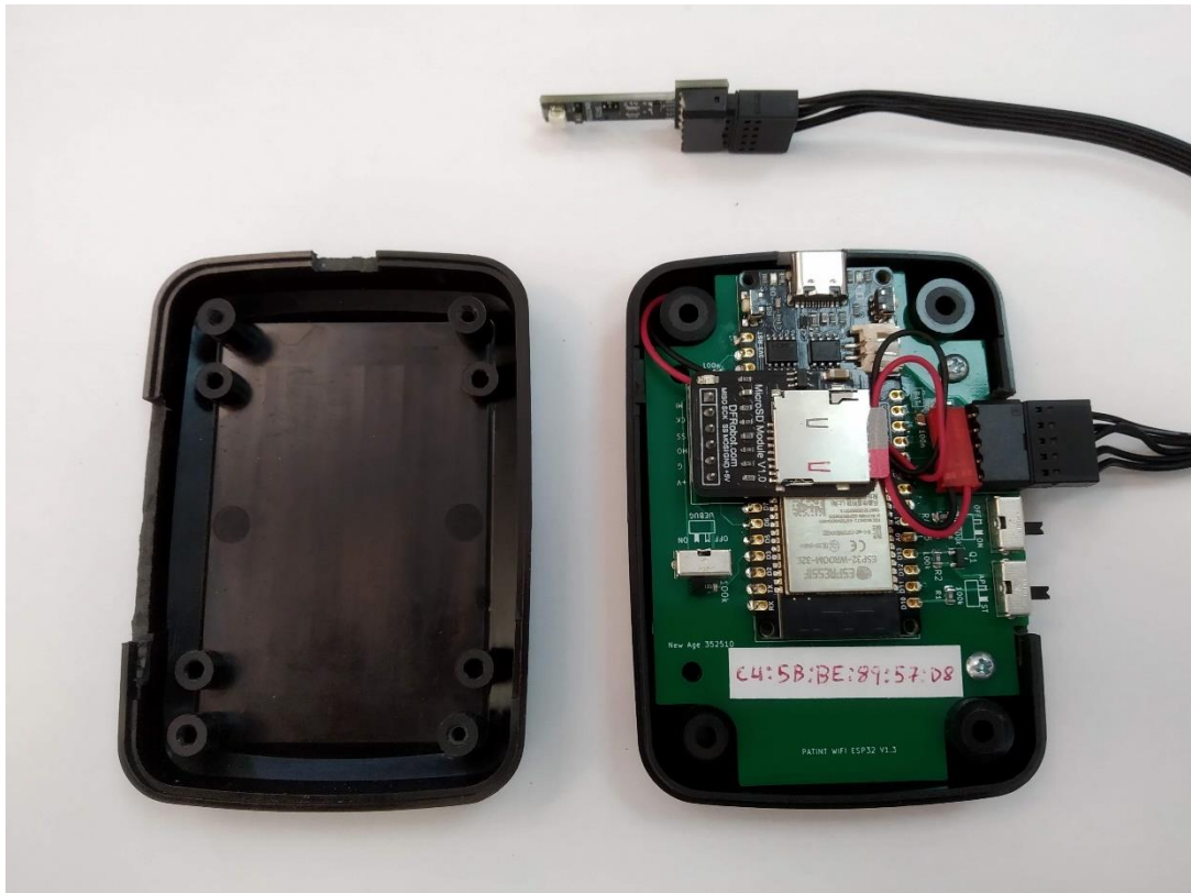
Imagen 26. Nuevo sensor PATINT. El nuevo módulo DIPP_WIFI está dentro de la caja de plástico negro, y el nuevo módulo DIPP_SENS (parte superior de la fotografía) está conectado a DIPP_WIFI.
