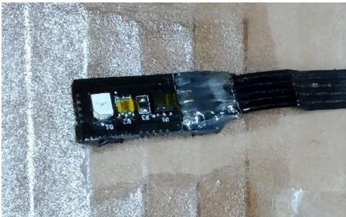
Imagen 21. Detalle del anterior módulo DIPP_SENS. El adhesivo era necesario para fijar el cable a la placa.
