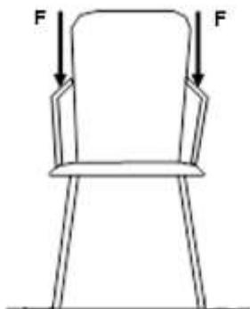
En asientos con dos brazos, que estén a una distancia entre centro menor de 1000 mm, aplicar la fuerza simultáneamente en ambos brazos, en los puntos más desfavorables, pero no a menos de 100 mm de cualquier extremo de la estructura del brazo. Para la aplicación de fuerzas emplear el útil 5.5 o 5.7
