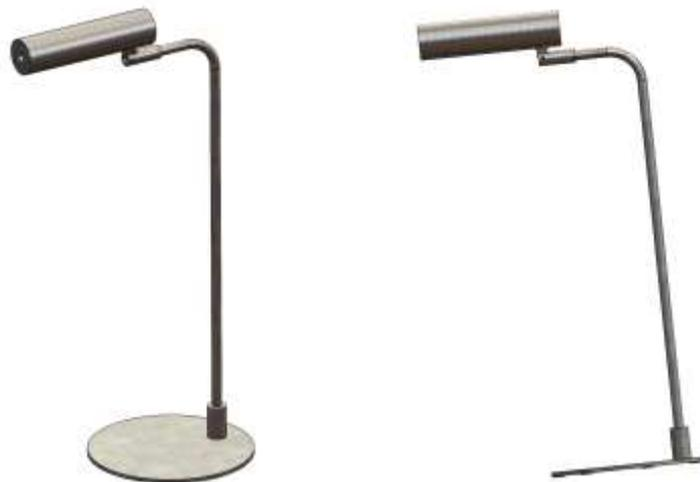
La base del modelo 3D se divide en 7 puntos de los cuales se analizarán las reacciones que la gravedad produce sobre estos en un plano inclinado:
