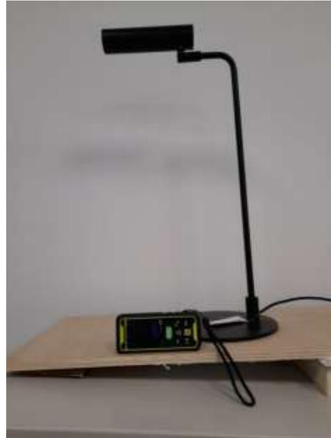
El resultado que se obtiene utilizando un inclinómetro para el vuelco de la lámpara es de 15.8º de inclinación. Satisfaciéndose así los requisitos de la norma que aplica a este producto.
