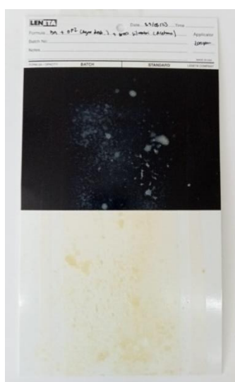
Figura 16. Probetas B1 + Taray OP2 + EXHID-13 en espray para ensayar eficacia contra bacterias.
