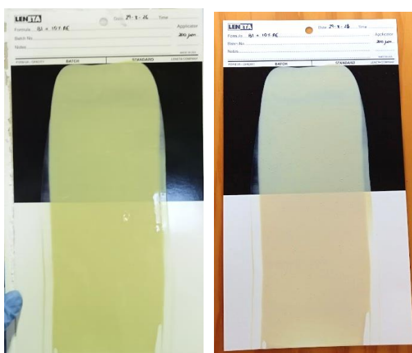
Figura 14. Aspecto de la aplicación B1 + AE al 10% húmeda (izquierda) y pasadas 24 horas (derecha).
