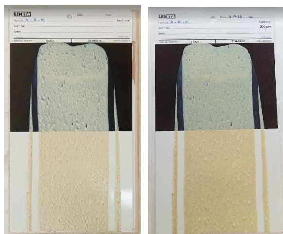
Figura 17. Aspecto de la aplicación B1 + AE al 10% + HTC-1-Ruta-2 al 1% húmeda (izquierda) y pasadas 24 horas (derecha).
