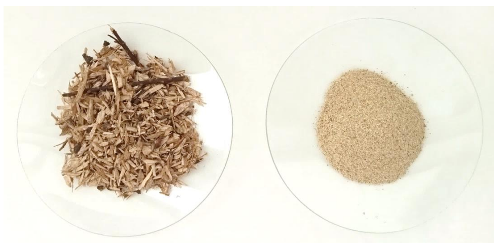
Figura 3. Residuo biomásico de restos de poda de Tamarix sp , antes del pretratamiento de reducción de tamaño de partícula (izquierda) y en formato polvo tras realizar pretratamiento (derecha)
