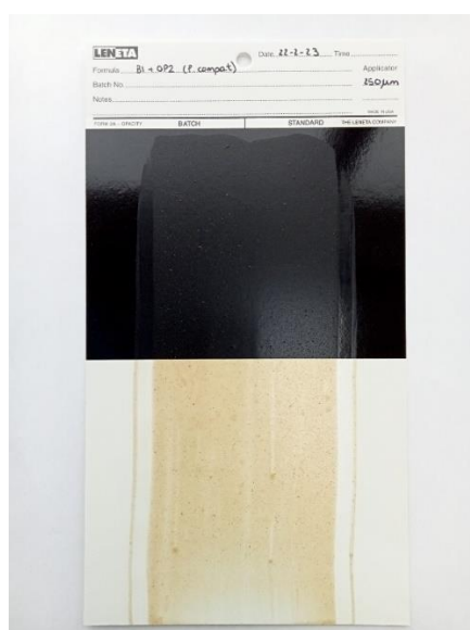
Figura 6. Mezcla recubrimiento B1 y Taray OP2 (disuelto en agua) al 1% sobre la superficie de cartulina de contraste.
