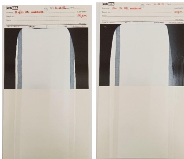
Figura 8. Aplicación del HTC-1 en un 2,5% (izda.) y 5 % (dcha.) con la pintura P1 .
