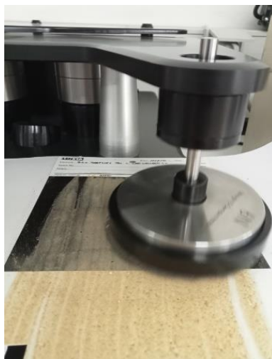
Figura 21. Ensayo de rayado de la superficie del B1 + Taray OP2 al 14% + HTC-1-Ruta-2 al 1%.
