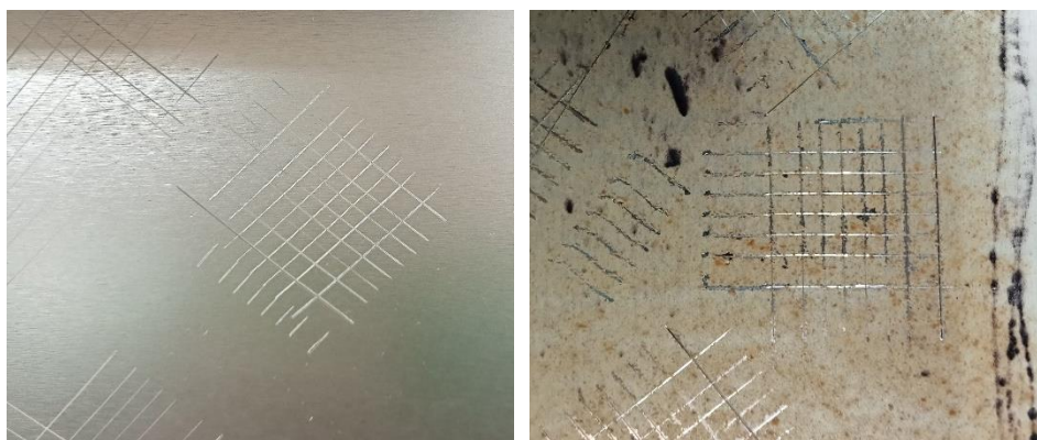
Figura 19. Resultados de ensayo de adherencia del blanco B1 y el recubrimiento B1+ Taray OP2 al 14% + HTC-1-Ruta-2 al 1%.
