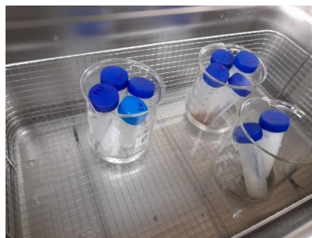
Ilustración 6. Método de extracción mediante ultrasonidos
