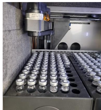
Ilustración 8. Inyección de calibrado y extracciones en HPLC
