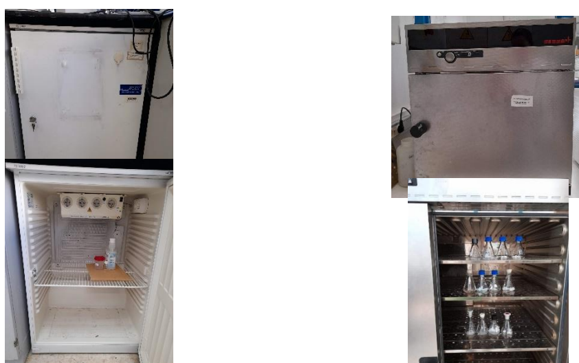
Ilustración 14. Cámara climática 20 °C (izq.); estufa 70 °C (dcha.)
