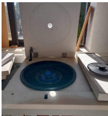
Ilustración 7. Método de extracción mediante centrifuga
