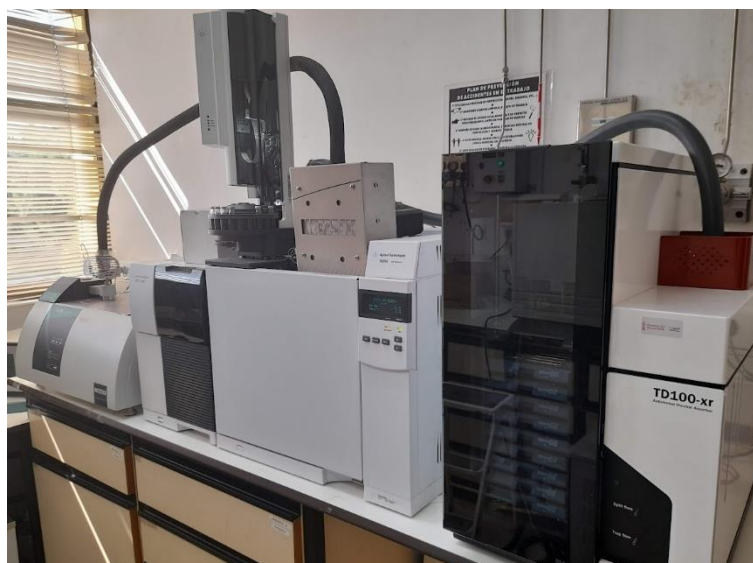
Ilustración 24. Equipo de termodesorción acoplado a cromatografía de gases masas (GC-MS)
