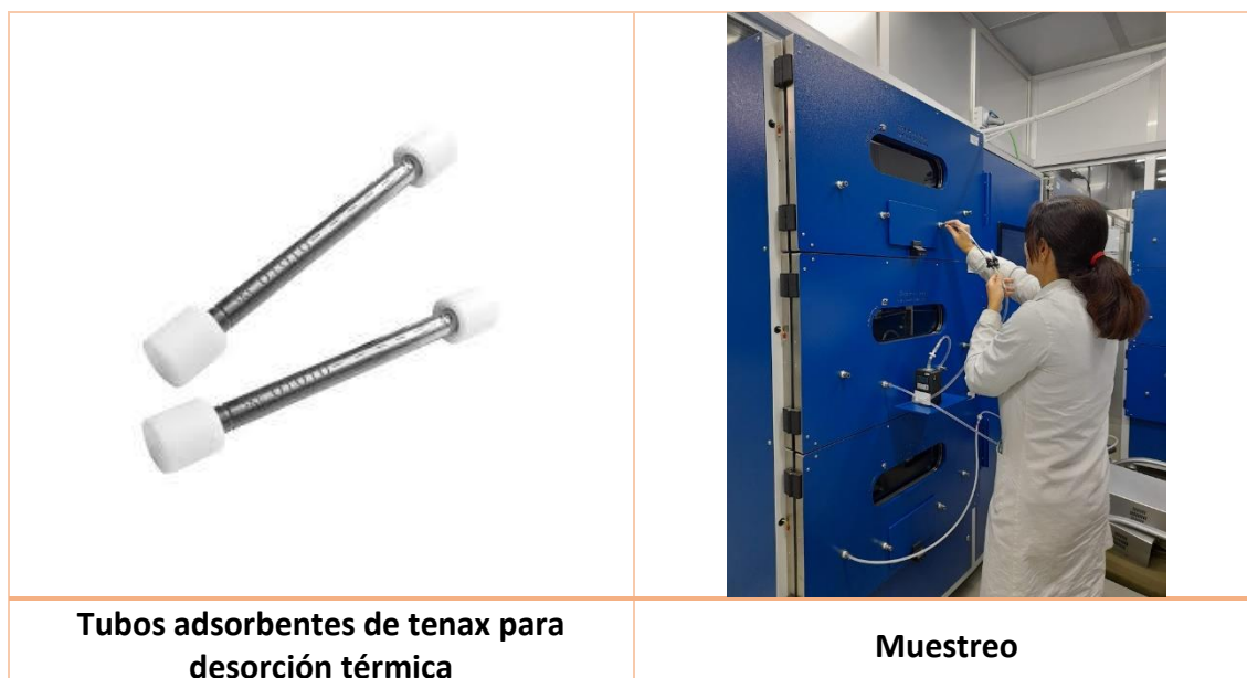
Ilustración 23. Procedimiento de ensayo para COV'S mediante tenax
