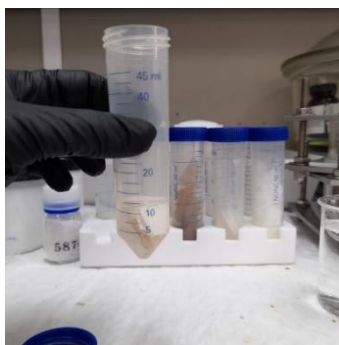
Ilustración 5. Tubo de centrifuga con la muestra objeto de estudio y la posterior adición del disolvente de extracción
