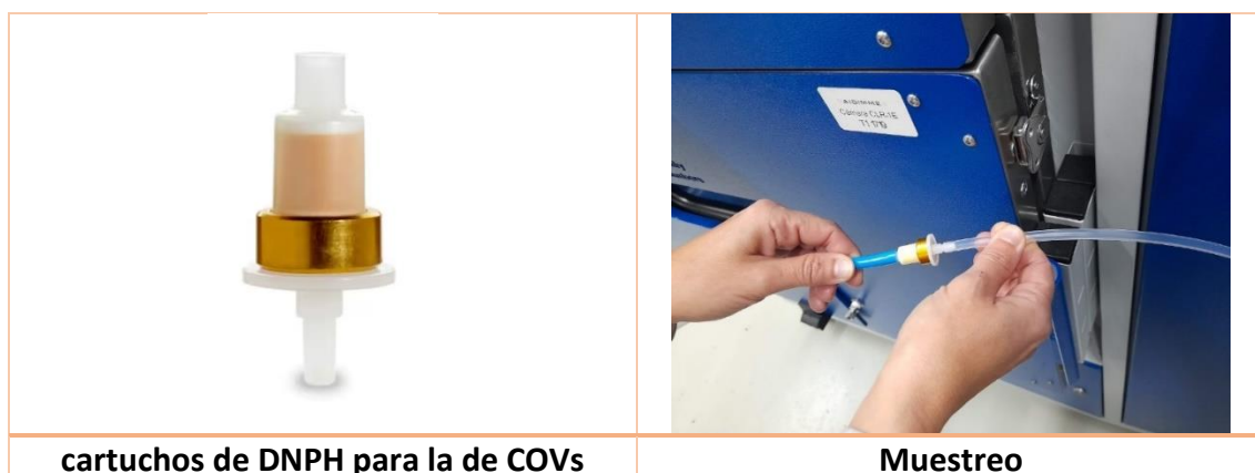
Ilustración 26. Procedimiento de ensayo para COV'S mediante tenax
