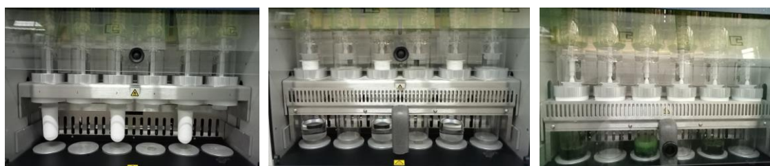
Colocación de cartuchos de celulosa
