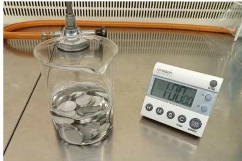
Figura 46. Discos de acero de 2 cm siendo esterilizados en Decon al 5% durante 60 minutos.
