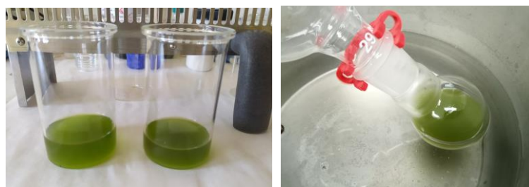
Figura 30. Extracto SM-R sin concentrar (izquierda) y balón de destilación con extracto durante el proceso de concentración (derecha).
