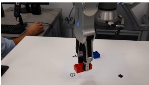
Figura 50: Ejemplo de pieza agarrada por su centro geométrico Fuente: elaboración propia
