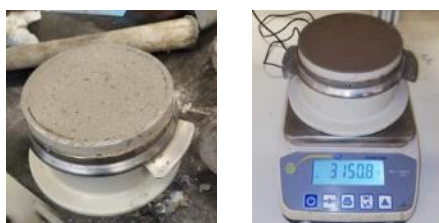
Figura 10. Material y método para la determinación de la densidad aparente del mortero fresco
