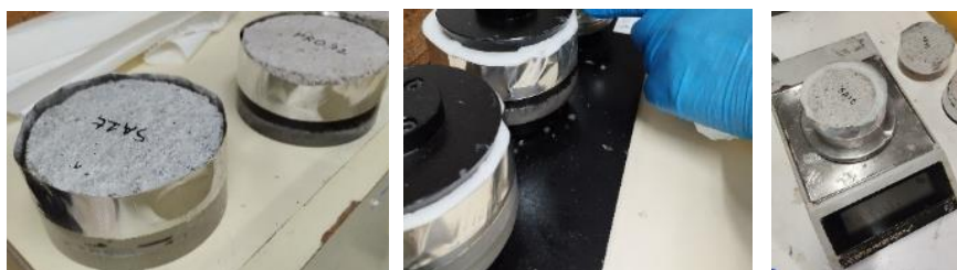
Figura 13. Imágenes de algunas etapas del ensayo de permeabilidad al vapor de agua
