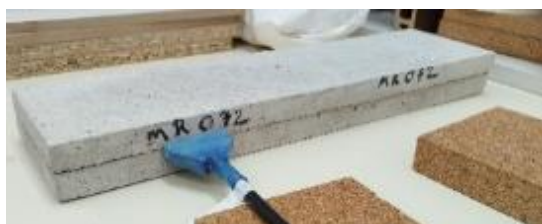
Figura 12. Ensayo de conductividad térmica por el método del hilo caliente
