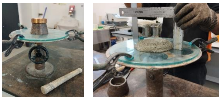
Figura 8. Material y procedimiento para determinar la trabajabilidad por el método de la mesa de sacudidas
