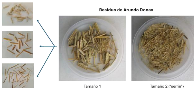
Figura 3. Inspección visual de las fibras de A. Donax suministradas por PILCANS
