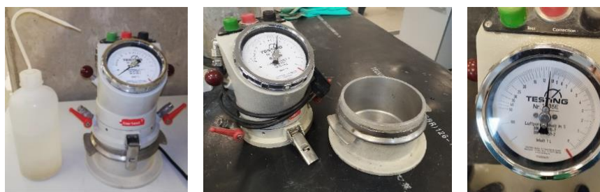
Figura 9. Anemómetro empleado para la medida de aire ocluido en fresco de mezclas de bio-morteros
