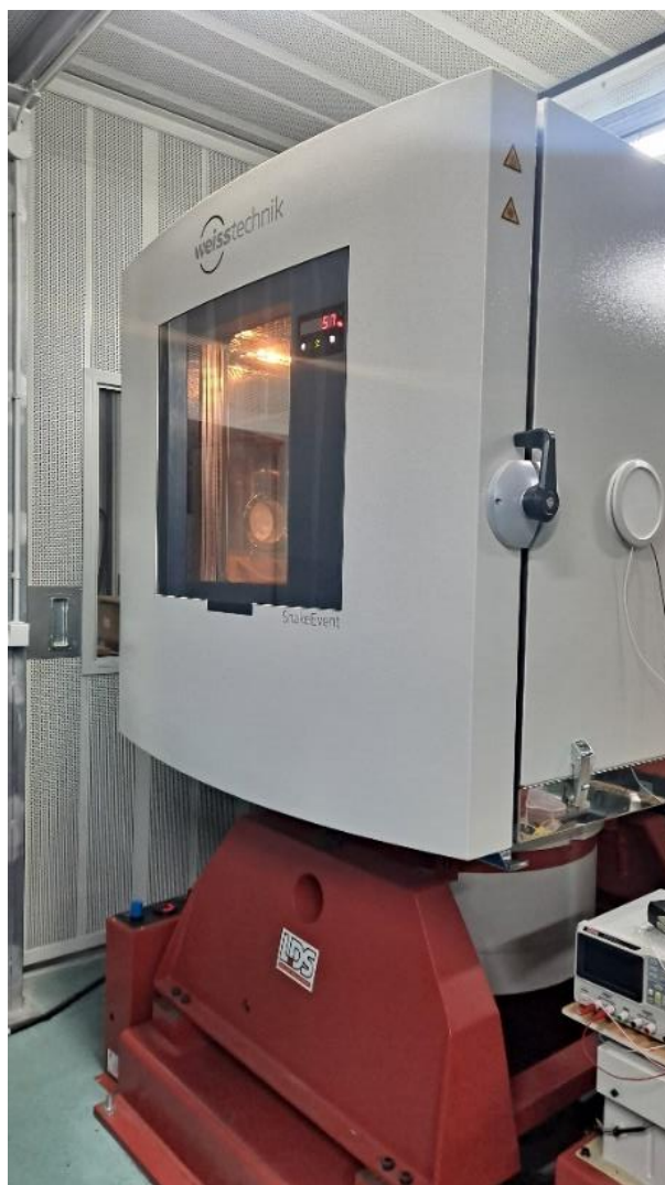
Combinación de equipo de vibración y choque LDSv850 y cámara climática Weiss
