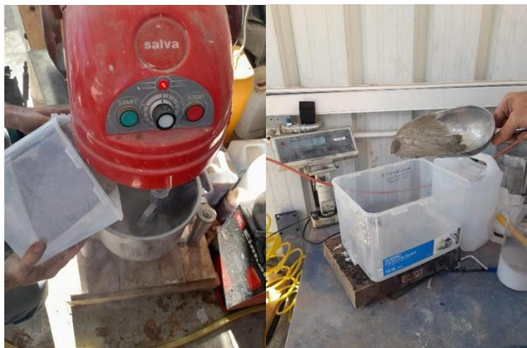
Figura 9 Preparación del mortero en un mezclador (imagen izquierda). Pesado del cemento (imagen derecha).
