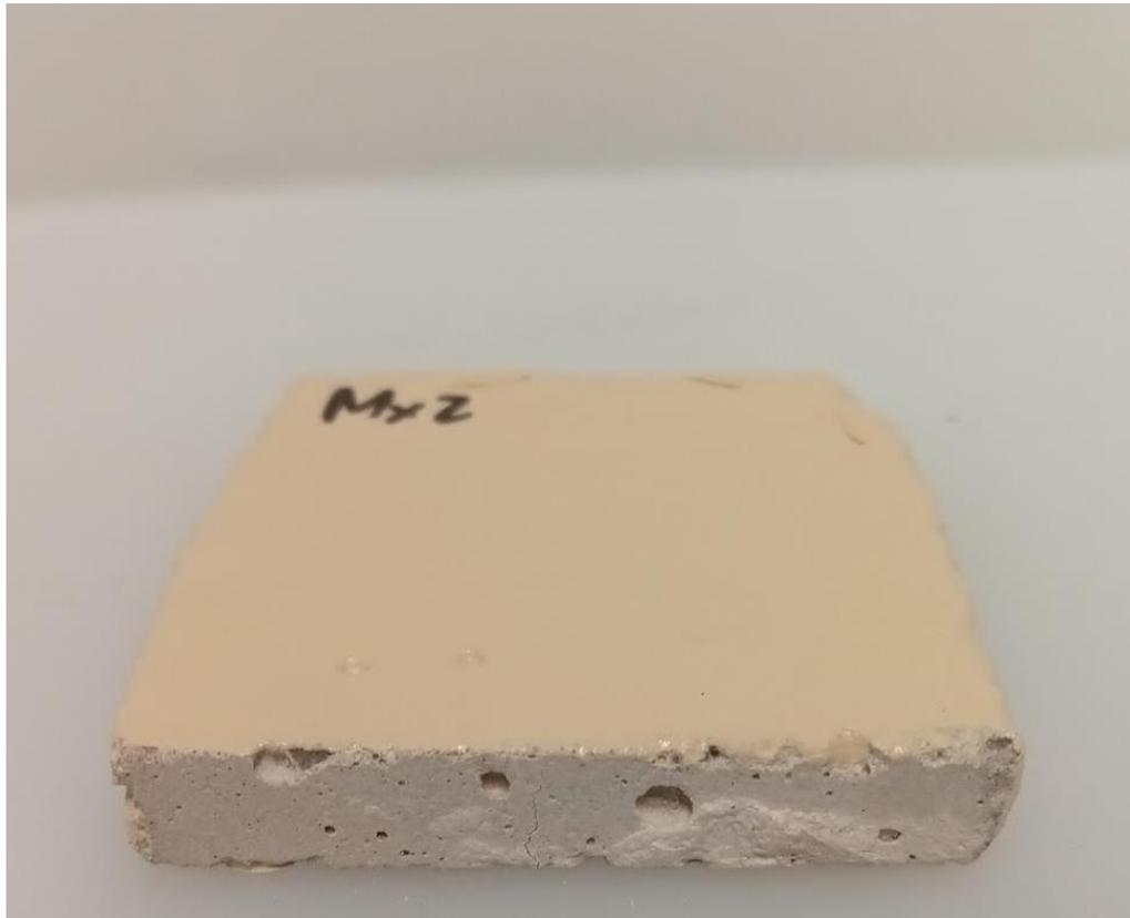
Figura 22 Muestra de mortero con una de las grietas sin recubrimiento Epoxi aplicado, para ensayar la capacidad de absorción.
