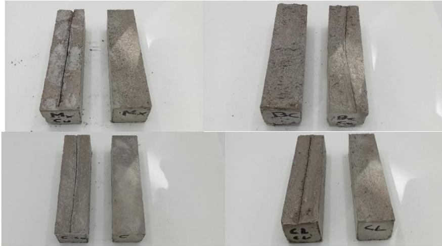
Figura 11 Muestras de mortero preparadas, control, control con lactato de calcio, inoculadas con *Bacillus cohnii* e inoculada con *Myxococcus xanthus*.
