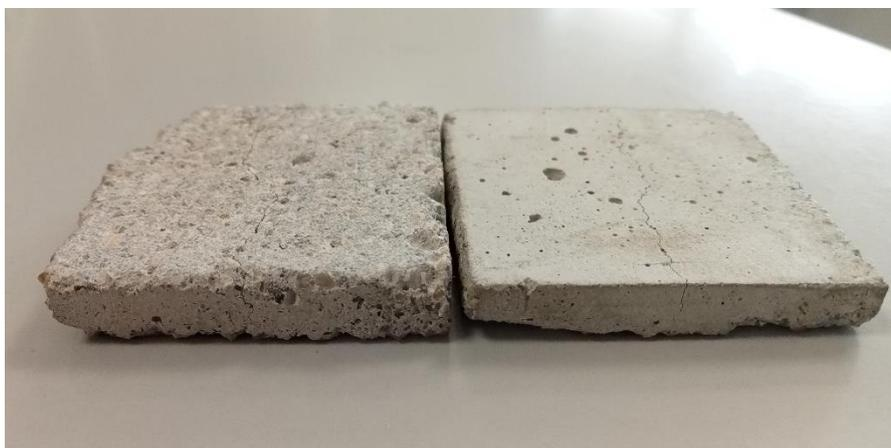
Figura 13 Muestras de mortero de 40mm x 40mm x 5mm fracturadas con presión en tres puntos.
