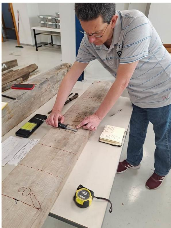
Imagen 25. Medida y posicionamiento de los nudos en la cara de una vigueta acopiada en Alcoi.
