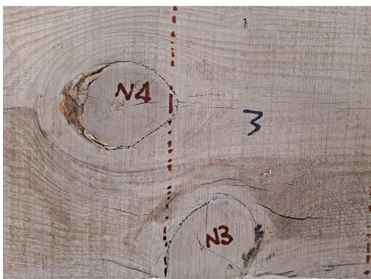
Imagen 26. Ejemplo de nudos medidos, numerados y posicionados (vista parcial de una vigueta acopiada).
