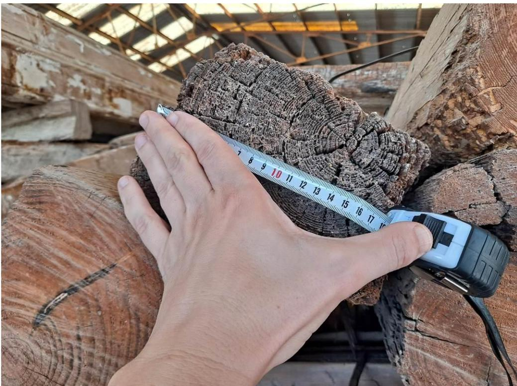
Imagen 14. Toma de medidas durante la selección de viguetas para su adquisición en el proyecto (5).
