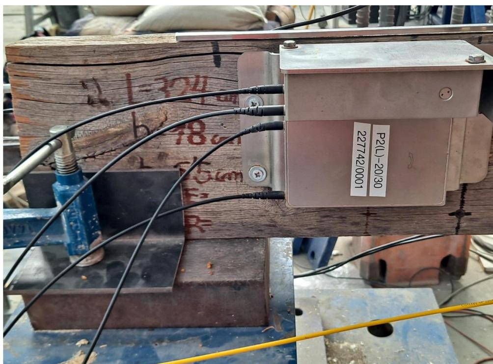
Imagen 38. Cables de los sensores conectados a un concentrador, que a su vez va conectado a un ordenador.
