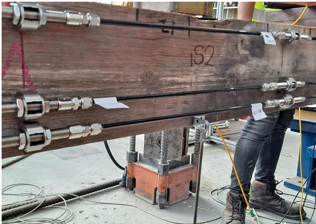
Imagen 34. Detalle de los transductores de desplazamiento lineal variable (tres sensores en posición longitudinal).
