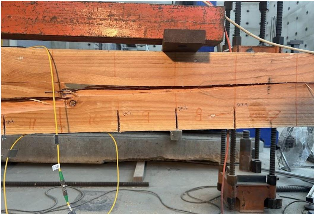
Imagen 52. Detalle de la rotura de una vigueta durante un ensayo de flexión.
