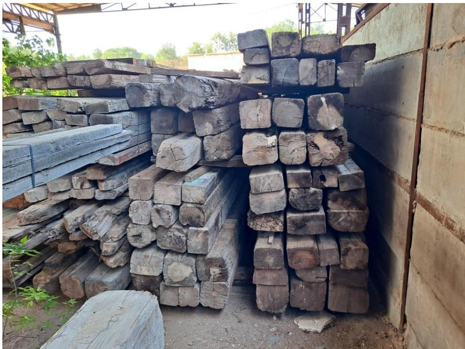
**Imagen 9. Ejemplo de lotes de viguetas que fueron examinados para seleccionar viguetas útiles para el proyecto (2). Puede observarse que la sección no siempre es del todo rectangular.**
