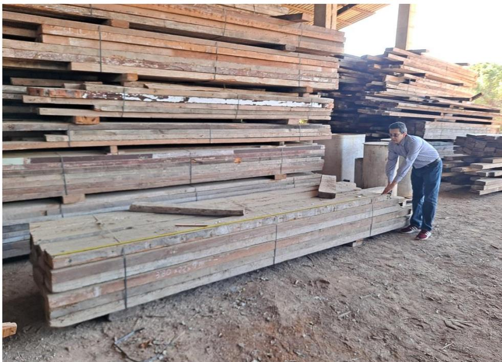
Imagen 12. Toma de medidas durante la selección de viguetas para su adquisición en el proyecto (3).
