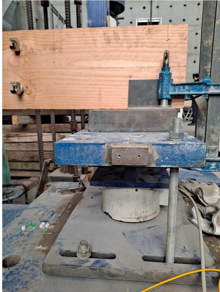
Imagen 31. Apoyo lateral de un extremo del sistema, en el cual puede verse la célula de carga que se utiliza para medir las reacciones durante los ensayos de flexión.
