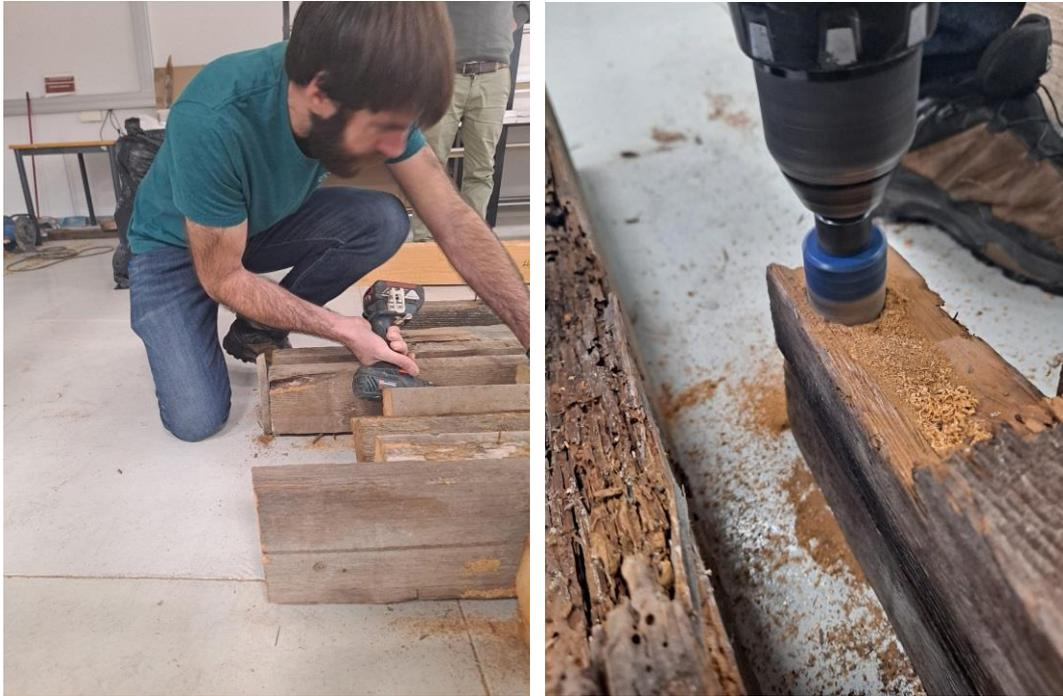
Imagen 19. Taladrado previo de las viguetas para la posterior realización del ensayo de emisión-recepción de ultrasonidos.
