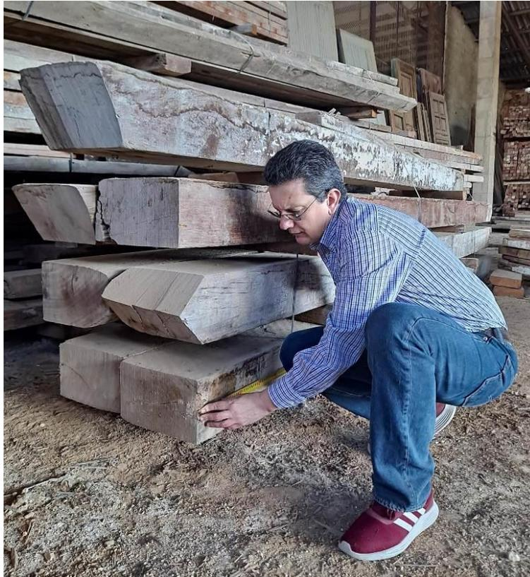
Imagen 11. Toma de medidas durante la selección de viguetas para su adquisición en el proyecto (2).
