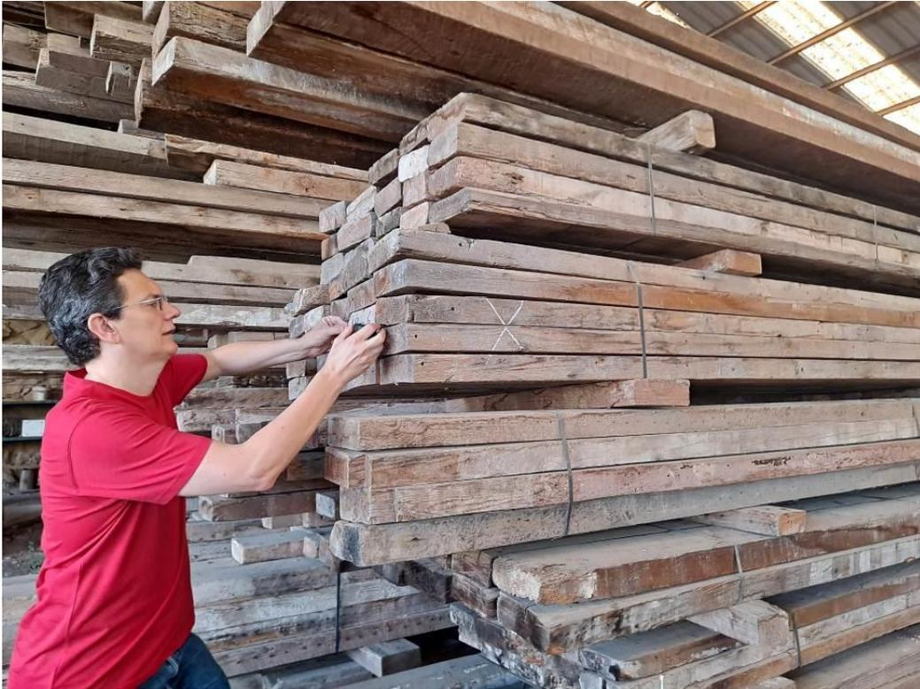
Imagen 13. Toma de medidas durante la selección de viguetas para su adquisición en el proyecto (4).
