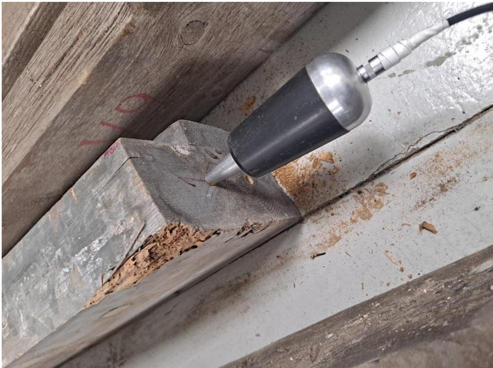
Imagen 20. Uno de los transductores usados en el ensayo de emisión-recepción de ultrasonidos.
