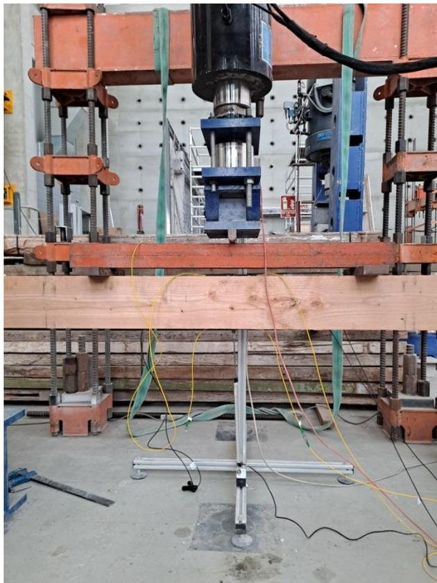
**Imagen 30. Vista frontal de sistema de ensayo a flexión con el nuevo sistema avanzado de monitorización. Detrás puede verse un lote de viguetas de madera antigua acopiadas para el proyecto, que se ensayaron una vez verificado y calibrado el sistema.**
