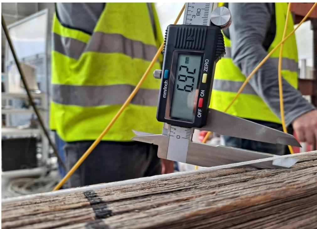
Imagen 37. Verificación de las deformaciones obtenidas mediante los sensores con la obtenida mediante un pie de rey digital calibrado.
