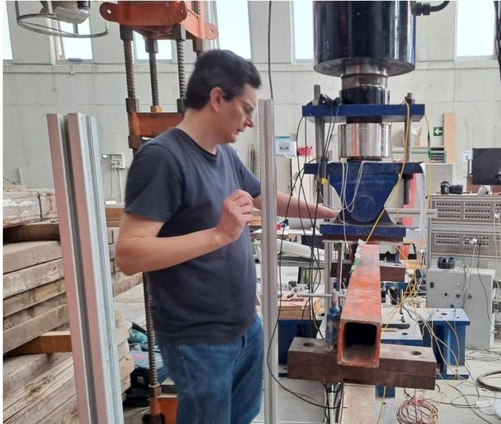
**Imagen 29. Montaje del sistema de ensayo a flexión con el nuevo sistema avanzado de monitorización.**
