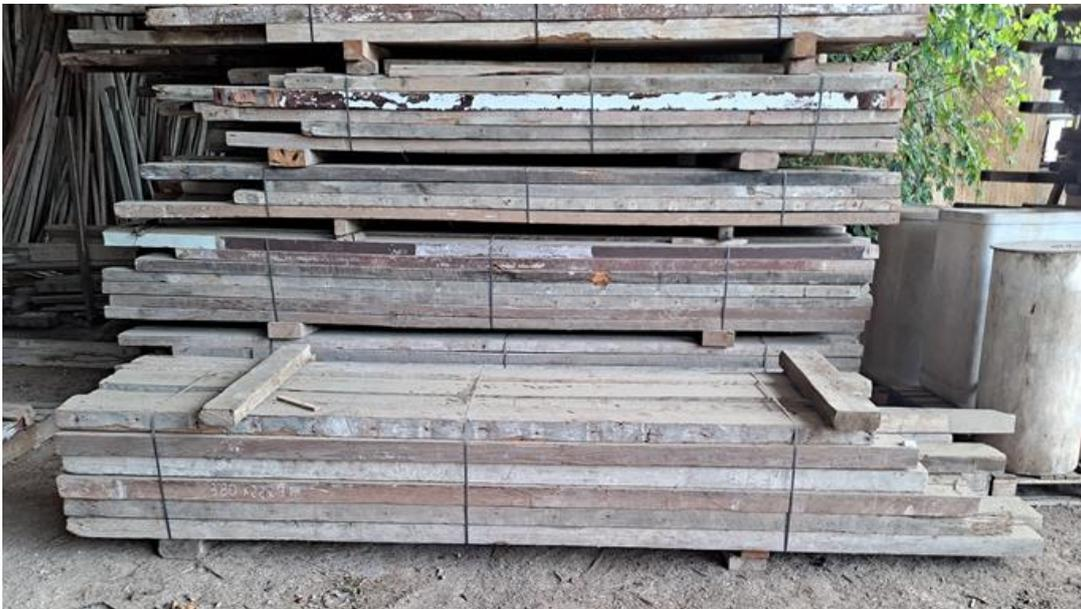
**Imagen 8. Ejemplo de lotes de viguetas que fueron examinados para seleccionar viguetas útiles para el proyecto (1).**
