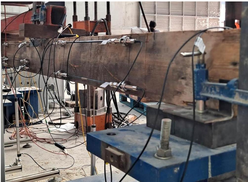
**Imagen 28. Sistema de ensayo a flexión, que realiza ciclos de carga y descarga a velocidad programable, integrado con el nuevo sistema avanzado de monitorización.**
