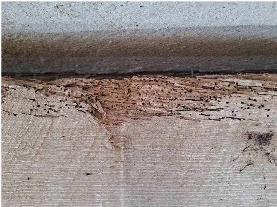
**Imagen 17. Degradación en la parte lateral de una de las viguetas acopiadas. Esta degradación, causada por carcoma gruesa, es superficial (afecta a 1-2 cm de espesor) y no fue necesario sanear la vigueta.**
