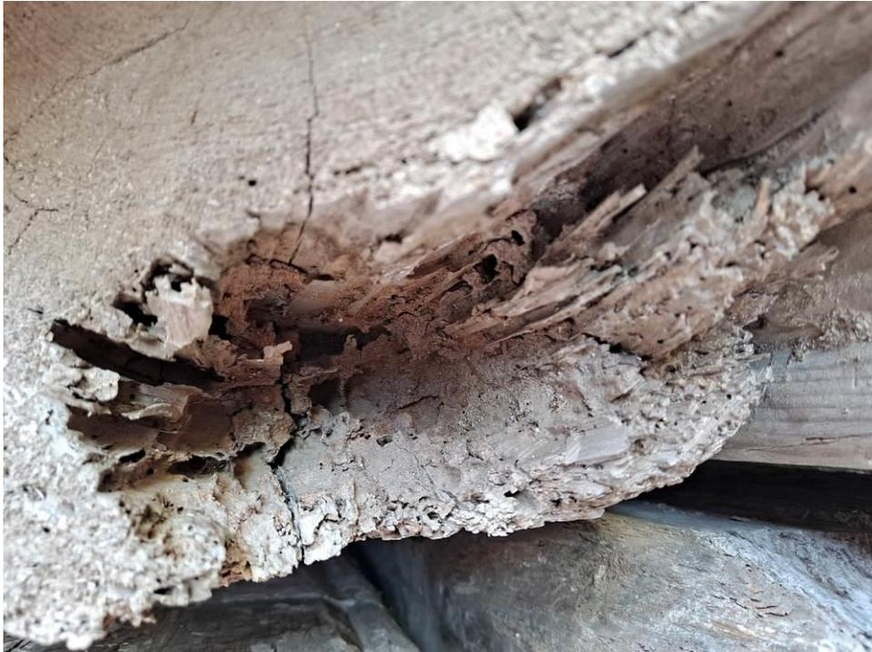
**Imagen 16. Degradación en el extremo de una de las viguetas acopiadas. Esta degradación, causada por hongos de pudrición, se saneó antes de acondicionar la vigueta.**
