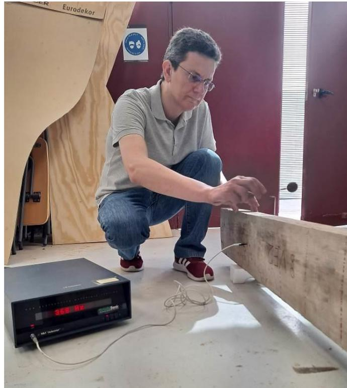
**Imagen 23. Realización de un ensayo de excitación por impulso en una de las viguetas acopiadas para el proyecto.**
