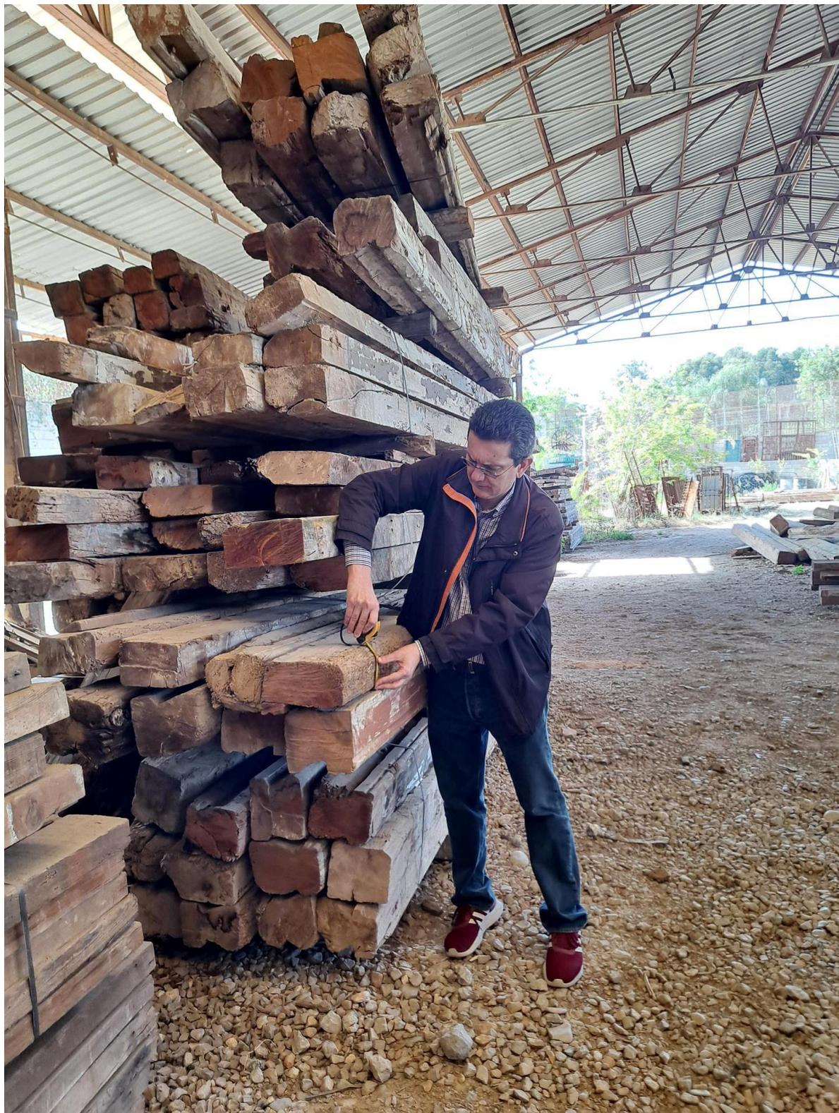
Imagen 10. Toma de medidas durante la selección de viguetas para su adquisición en el proyecto (1).
