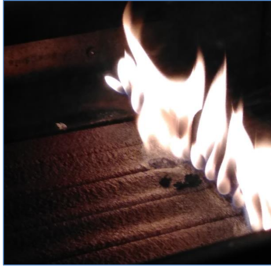
Figura 36 – WPF-PM-01. Superior izquierda: Antes del ensayo; Superior derecha: Después del ensayo; Inferior: Detalle carbonización durante la ignición.
