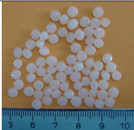
Figura 1 – Granza de polímero empleada para la producción de las probetas. Escala en centímetros.
