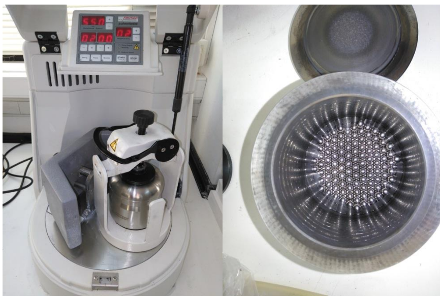
Figura 19 – Montaje del molino de bolas con giro planetario marca Fritsch modelo Pulverisette 6, con recipiente de tungsteno y bolas de acero.
