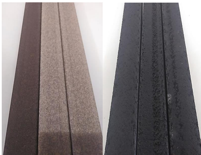
Figura 43 – Muestras WPF-PM-01 y WPF-PM-05 tras 3 meses de exposición natural. La réplica de control y las dos réplicas envejecidas de cada muestra.
