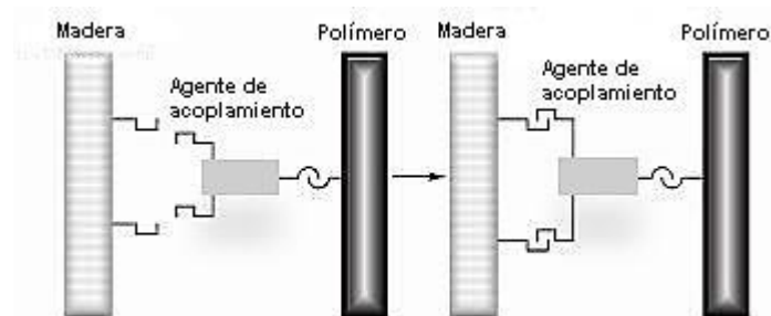
Figura 3 – Modo de actuación del agente de acoplamiento.
