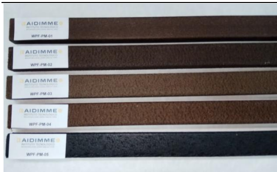
Figura 33 – Obtención de perfiles WPC con aditivos ignífugos.
