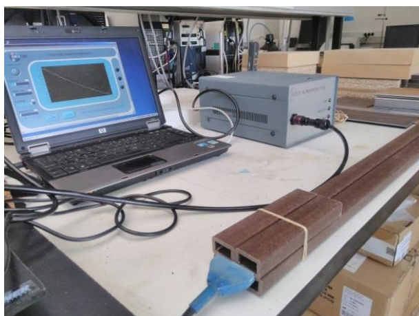
Figura 44 – Muestra WPF-PM-01 durante el ensayo de conductividad térmica.
