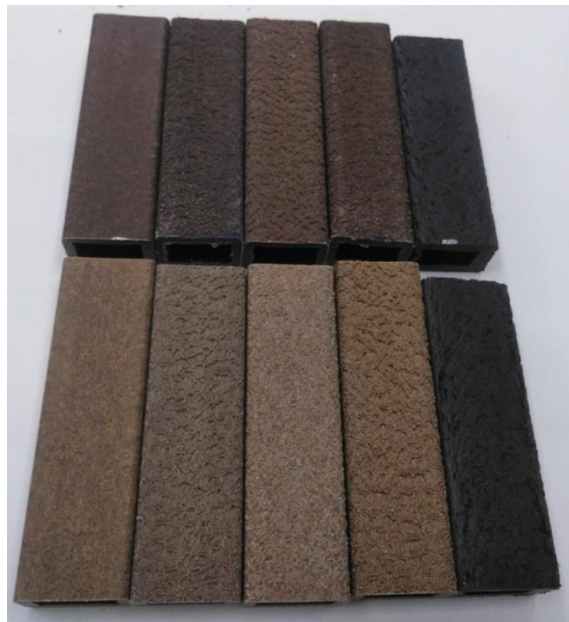
Figura 41 – Muestras tras 250 horas de exposición, abajo, comparadas con sus respectivas muestras de control, arriba.
