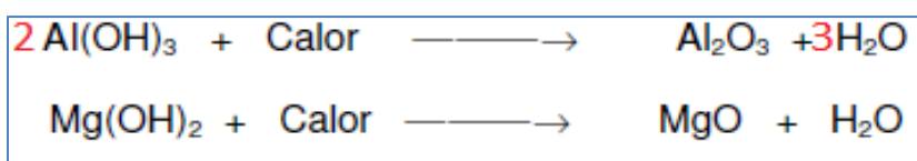
Figura 17 – Reacciones de descomposición de hidróxidos metálicos.
