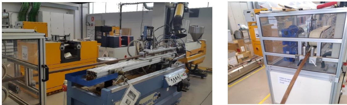
Figura 30 – Segunda etapa de extrusión: calibrador, baño de enfriado y carro de arrastre.
