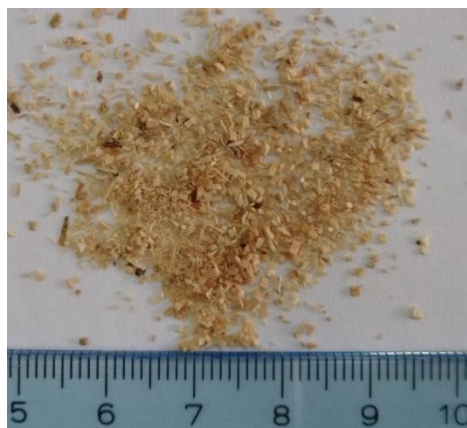
Figura 2 – Matriz celulósica empleada para la producción de las probetas.
