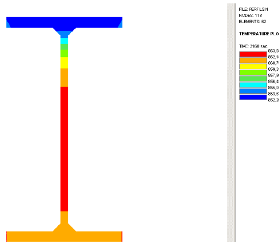
Figura 8. Ejemplo de perfil de temperaturas en una viga sometida a una carga de calor con el programa EFsteel.
