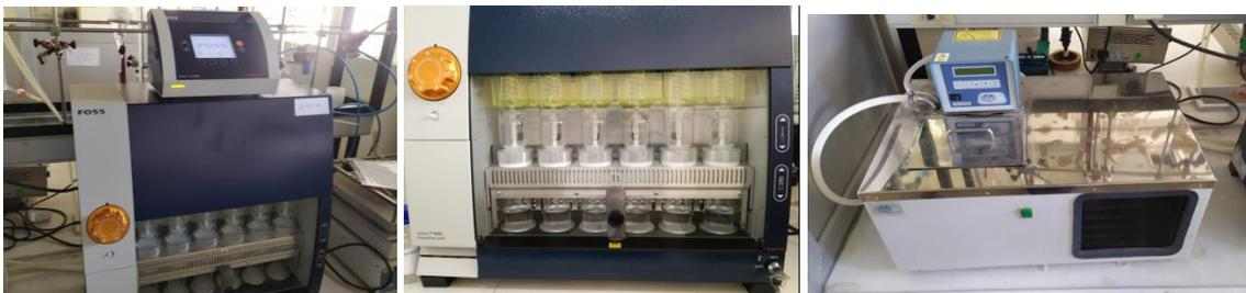
Figura 4. Unidad de extracción Soxtec™ 8000 y baño de refrigeración.
