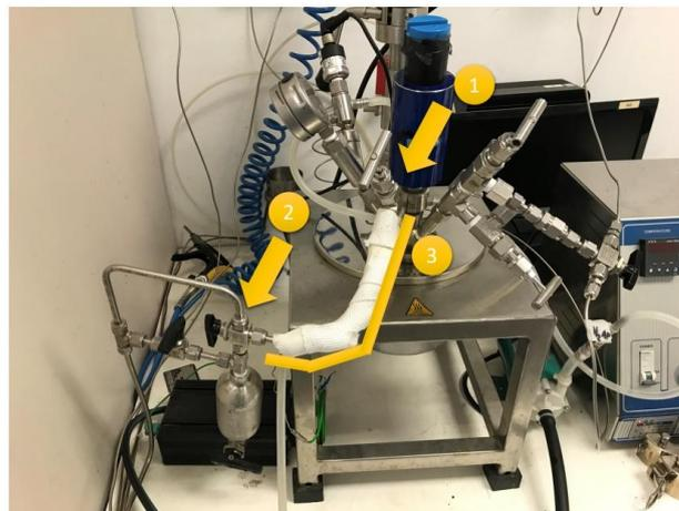
Figura 6: Autoclave con adaptación para la extracción de monoterpenos.
